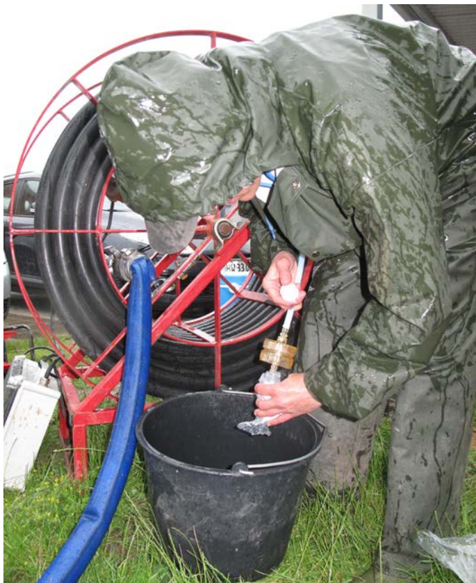
Figur 2. Online filtrering ved hjælp af pumpetryk.
