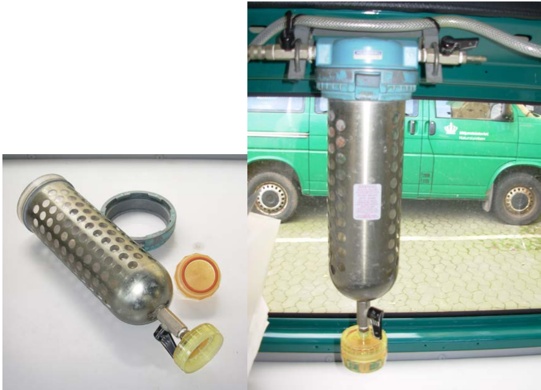
Figur 3. Trykfiltreringsudstyr fra LOOP og borer med utilstrækkeligt pumpetryk, her filterhus og filterholder, samt opstilling i feltbilen, med gas til trykfiltrering monteret.
