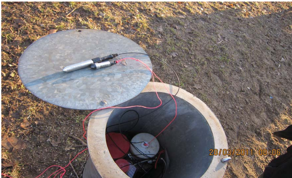
Figur 4. To forskellige modeller af tryktransducere før montering i boring. Den store ældre udgave og den lille nyere udgave.
