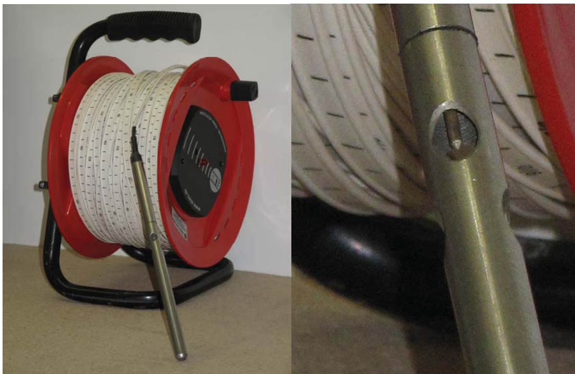
Figur 3. Manuelt pejle, hvor pejlet giver et signal, når der løber en strøm mellem de to elektroder i pejlet. Dette sker, når der er elektrisk ledende vand mellem elektroderne, se billedet til højre. NB. Der kan ske fejl, hvis vandet stammer fra kondens på forerøret. Grundvand med lav ledningsevne vil kun lede en mindre strøm, hvilket svækker signalstyrken.
