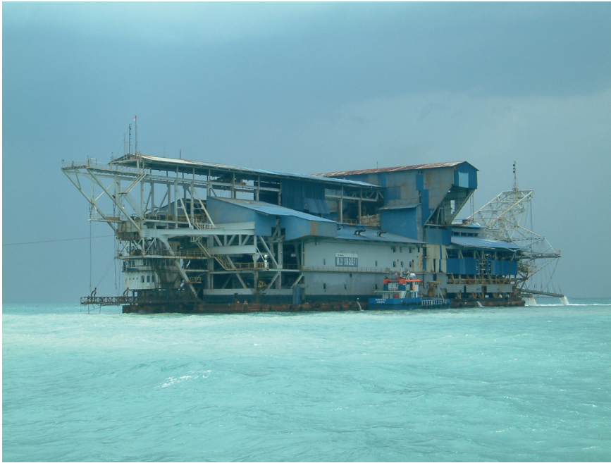
Tinudvindingen sker bl.a. fra marine tungsandsforekomster, hvor flydende ponton-spandkædemaskiner udvinder tin fra ca. 30 meters dybde som her ved Bangka Island, Indonesien (foto: © DERA).
