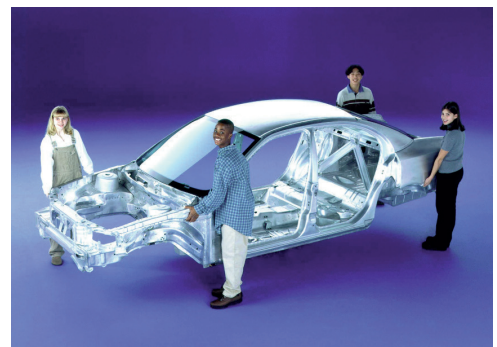
Anvendelse til transportmidler fx bilkarosserier, er det største brugsområde for aluminium pga. metallets høje styrke-vægtforhold (foto: Aluminium Association).
