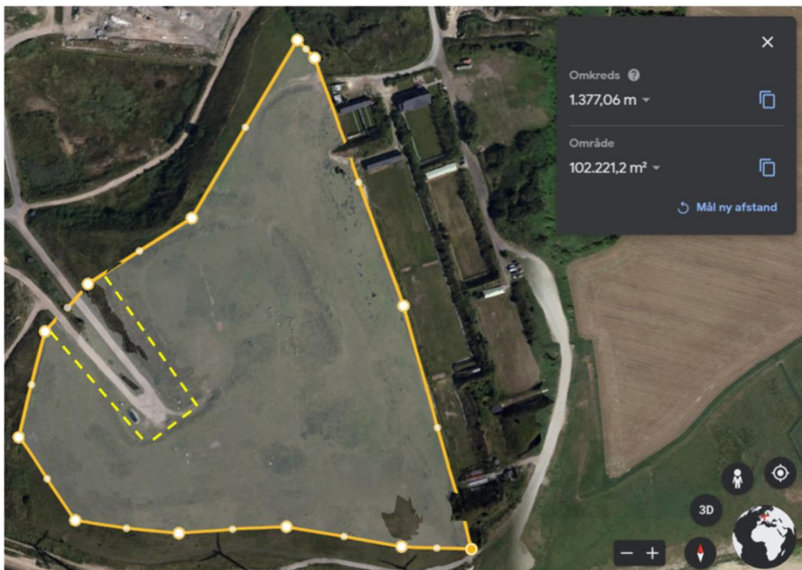
Figur 23 Beregnet areal for Måde Deponi. Den gule optrukne linje viser arealet for hele undersøgelsesområdet, mens stiplet gul linje indikerer delområde omkring pumpestation, som er fratrukket arealet for beregning af minimumsarealet i volumenestimeringen. Kort: Google Maps.
