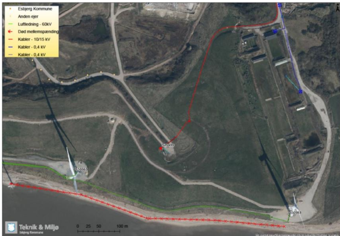
Figur 3 Luftledninger og kabler ved Måde Deponi. Kilde: Esbjerg Kommune. Kort: Google Maps.
