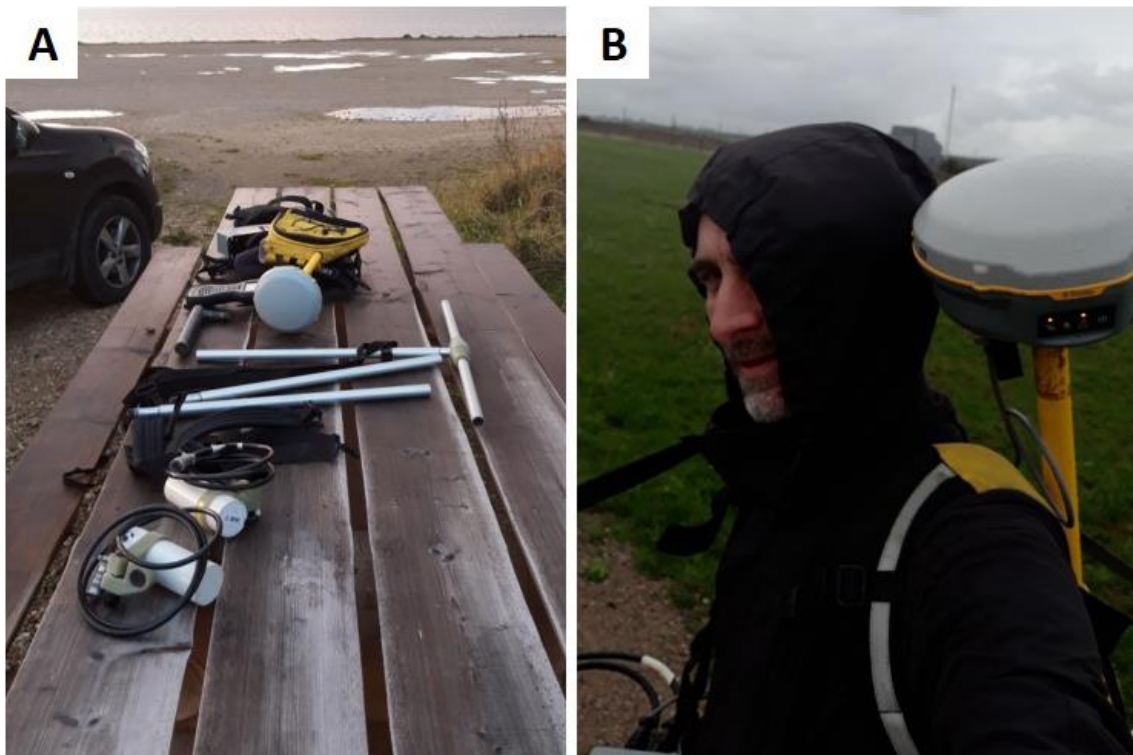
Figur 5 Feltarbejde med magnetometer. (A) Udstyr benyttet til den magnetiske undersøgelse som samles og bæres af en person. (B) Nærbillede af GPS-antenne som løbende registrerer de magnetiske målingers geografiske position under dataindsamling. Foto: MiMa.
