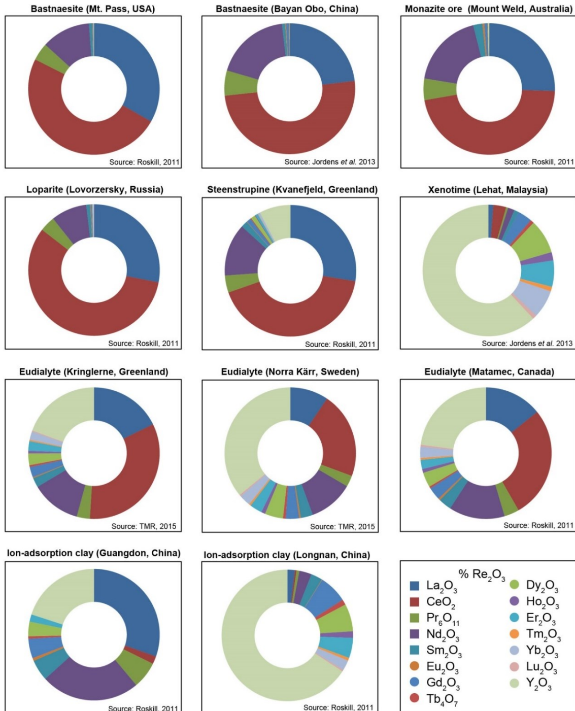
Figur 9-7 Fordelingen mellem de individuelle sjældne jordartsmetaller i forskellige mineraler og mellem samme type mineral, men dannet forskellige steder. Figur fra Machacek & Kalvig (2017).
