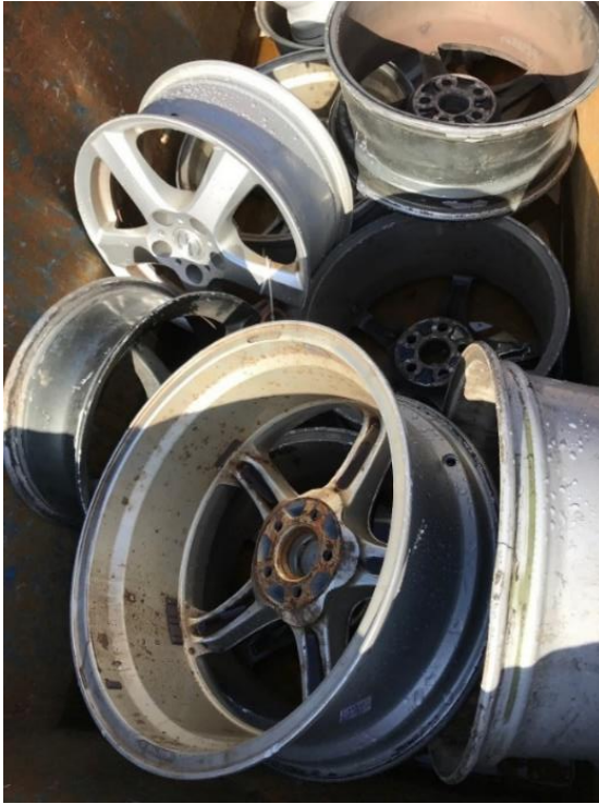
Figur 30 Støbte aluminiumfælg der bl.a. kan have indhold af silicium og magnesium. Foto: MiMa.
