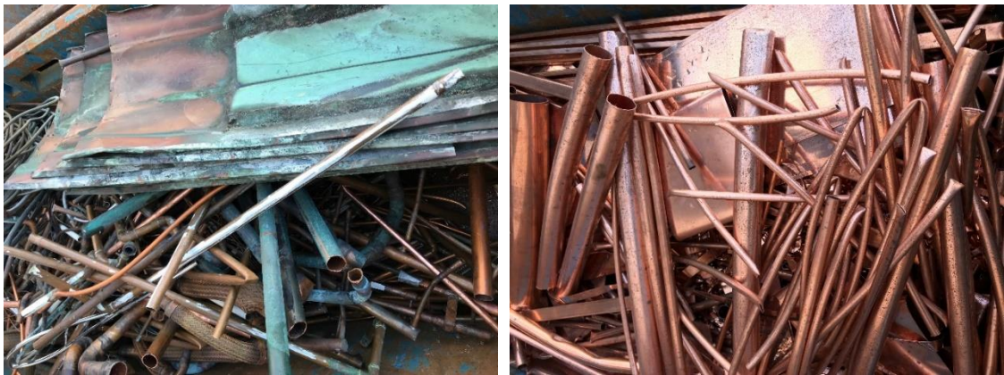
Figur 9 Eksempler på kobberskrot (også kaldet raffineringkobber) af forskellig renhedsgrad. Til venstre: kobberskrot med malingrester, ledninger og andre urenheder. Til højre: kobberskrot i form af rør, stænger og plader med høj renhed. Foto: MiMa.
