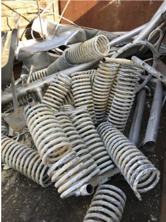
Figur 18 Blandet gammelt skrot af syrefast rustfrit stål, hvor der bl.a. ses stålspiraler, sandsynligvis fra varmtvandsbeholdere. Foto: MiMa.
