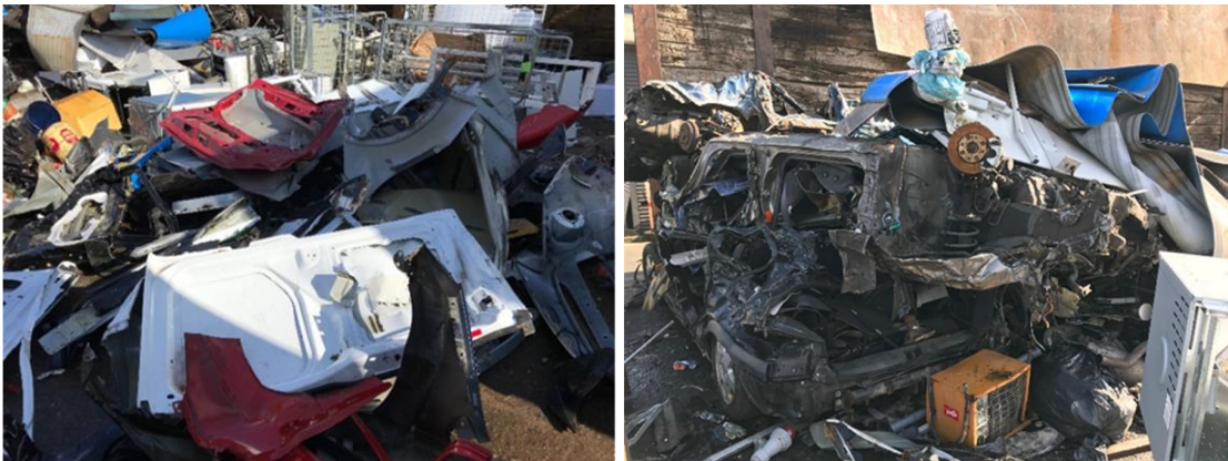
Figur 40 Miljøbehandlede biler klar til sortering inden behandling i en shredder. Til venstre: karosserier og døre. Til højre: udover selve karosseriet ses bremses, dæk, fjedre, udstødning og motor, der først shreds som en stor klump og efterfølgende udsorteres. Foto: MiMa.
