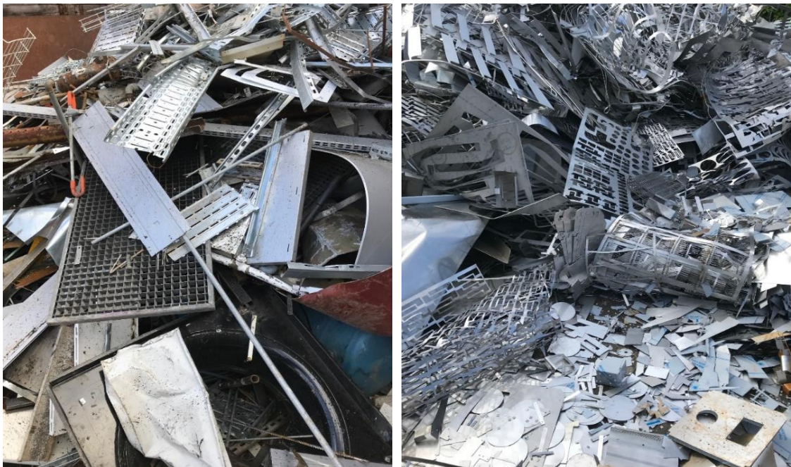
Figur 10 Eksempler på jernskrot. Til venstre: et parti gammelt jernskrot. Til højre: nyt almindeligt rustfrit stål (304, se afsnit 7.1.3) i form af afklip fra fremstillingsprocesser. Foto: MiMa.
