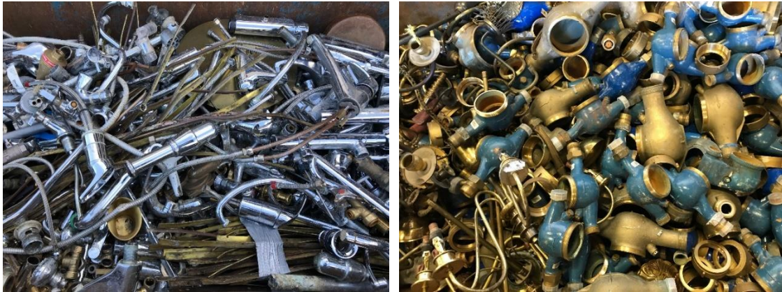
Figur 21 Messingskrot. Til venstre: blandet gammelt messingskrot af armaturer, vandhaner og andet. Til højre: VVS-fittings, adskilte vandmålere samt lysestager. Foto: MiMa.
