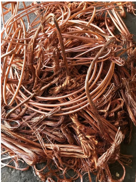
Figur 20 Rent kobberskrot af kabler og rør. Foto: MiMa.
