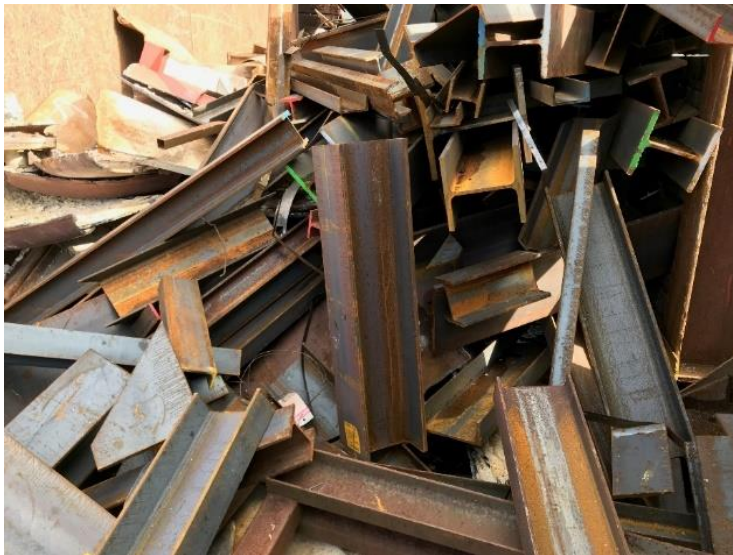
Figur 16 Et typisk eksempel på anvendelse af kulstofstål i form af stålbjælker, som bl.a. bruges i bygninger. Foto: MiMa.
