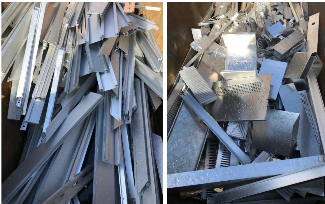
Figur 13 Forskellige former for aluminiumskrot. Til venstre: ekstruderinger og profiler af aluminium som kan have været brugt til vinduer. Til højre: aluminiumplader og -rammer. Foto: MiMa.
