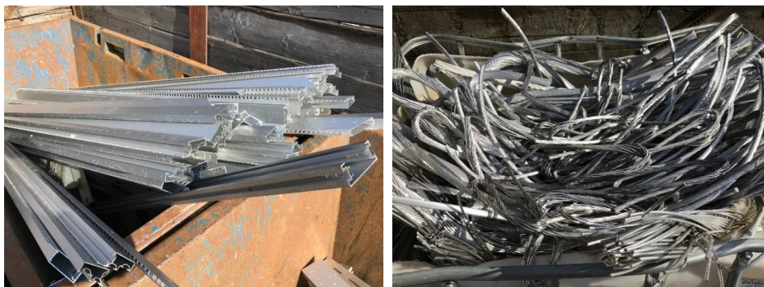
Figur 19 Aluminiumskrot. Til venstre: smedede aluminiumprofiler. Til højre: afskrællede aluminiumkabler. Foto: MiMa.
