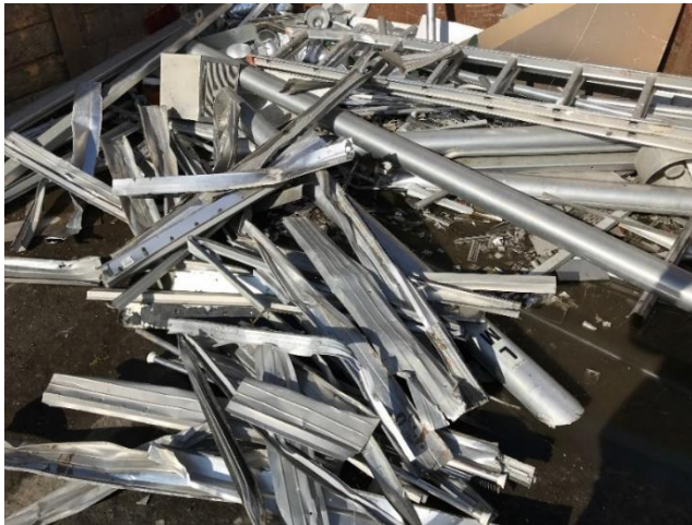
Figur 29 Gammelskrot af smedet aluminium såsom profiler, stænger samt en stige. Foto: MiMa.
