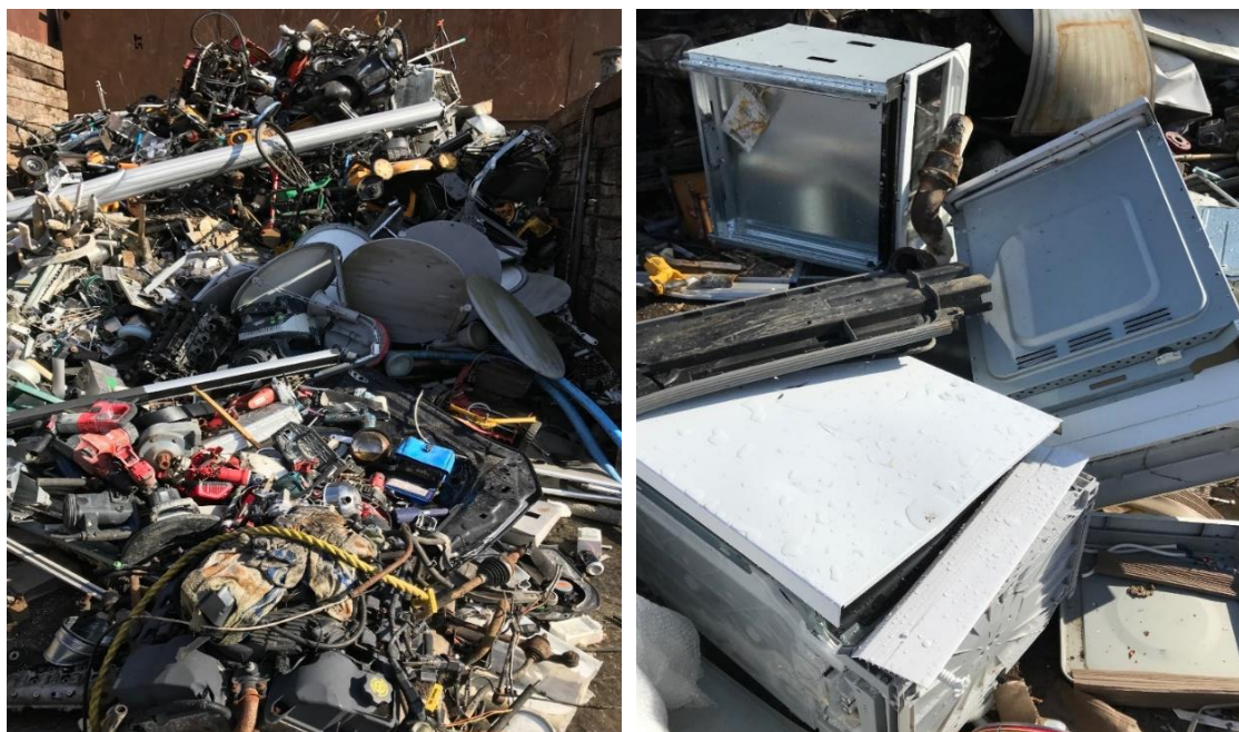
Figur 12 Shredderformateriale bestående af sammenblandet jern- og metalskrot. Til venstre ses bl.a. lamper, skinner, cykler, græsslåmaskiner, værktøj, køkkenredskaber og en bilmotor. Til højre: hårde hvidevarer. Foto: MiMa.
