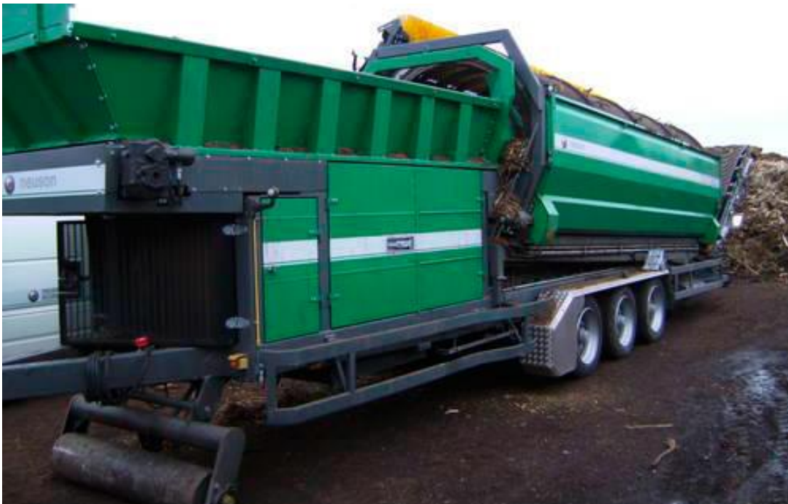
Figur 6 Sortering med Neuson-tromlesold ( neuson-ecotec.com ) ved LFM af dagrenovation på Miljøcenter Gerringe (RenoSam 2012).
