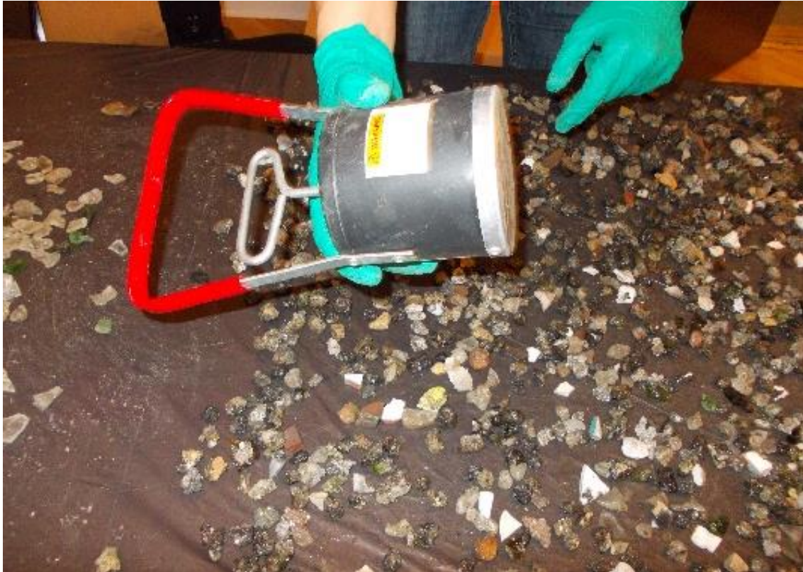
Figur 26. Permanent magnet til frasortering af magnetisk metal fra slaggen. Den har en styrke på 8 kg.
