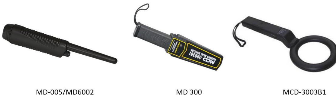
Figur 27. Forskellige modeller af håndholdte metaldetektorer (pinpointere) brugt til karakteriseringen. Modellen til venstre var den mest følsomme af de tre og dermed bedst.
