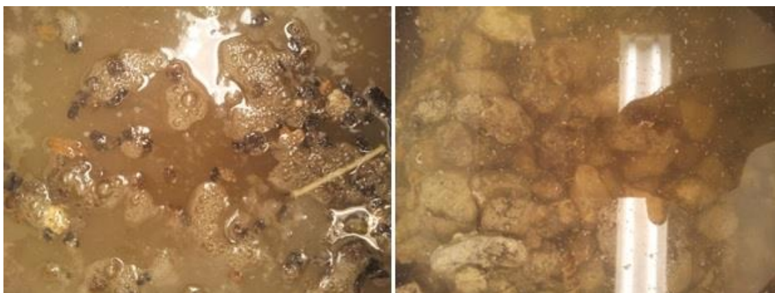
Figur 22. Til venstre ses spanden med første gang syre; til højre ses spanden med anden gang syre for fraktionen 8-16 mm. Der ses en tydelig forskel i syreopløsningens klarhed.
