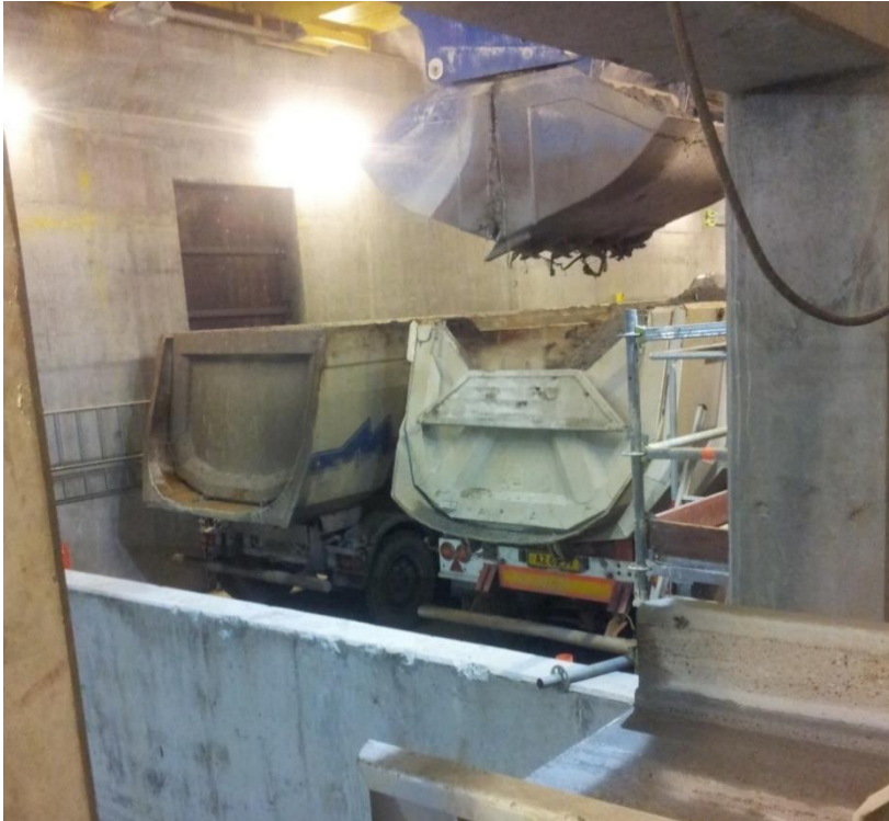
Figur 8. Slaggen fra båndet ender i siloen, hentes af grabben og læsses på lastbiler. Dette svarer til (4) og (5) i Figur 6.
