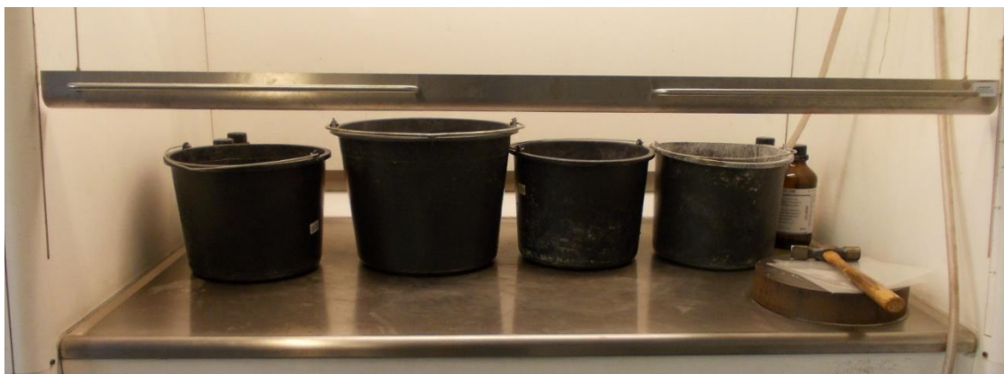
Figur 21. Stinkskab med spande med slaggefraktionerne 4-8 mm, 8-16 mm, 16-32 mm og 32-63 mm i syre.
