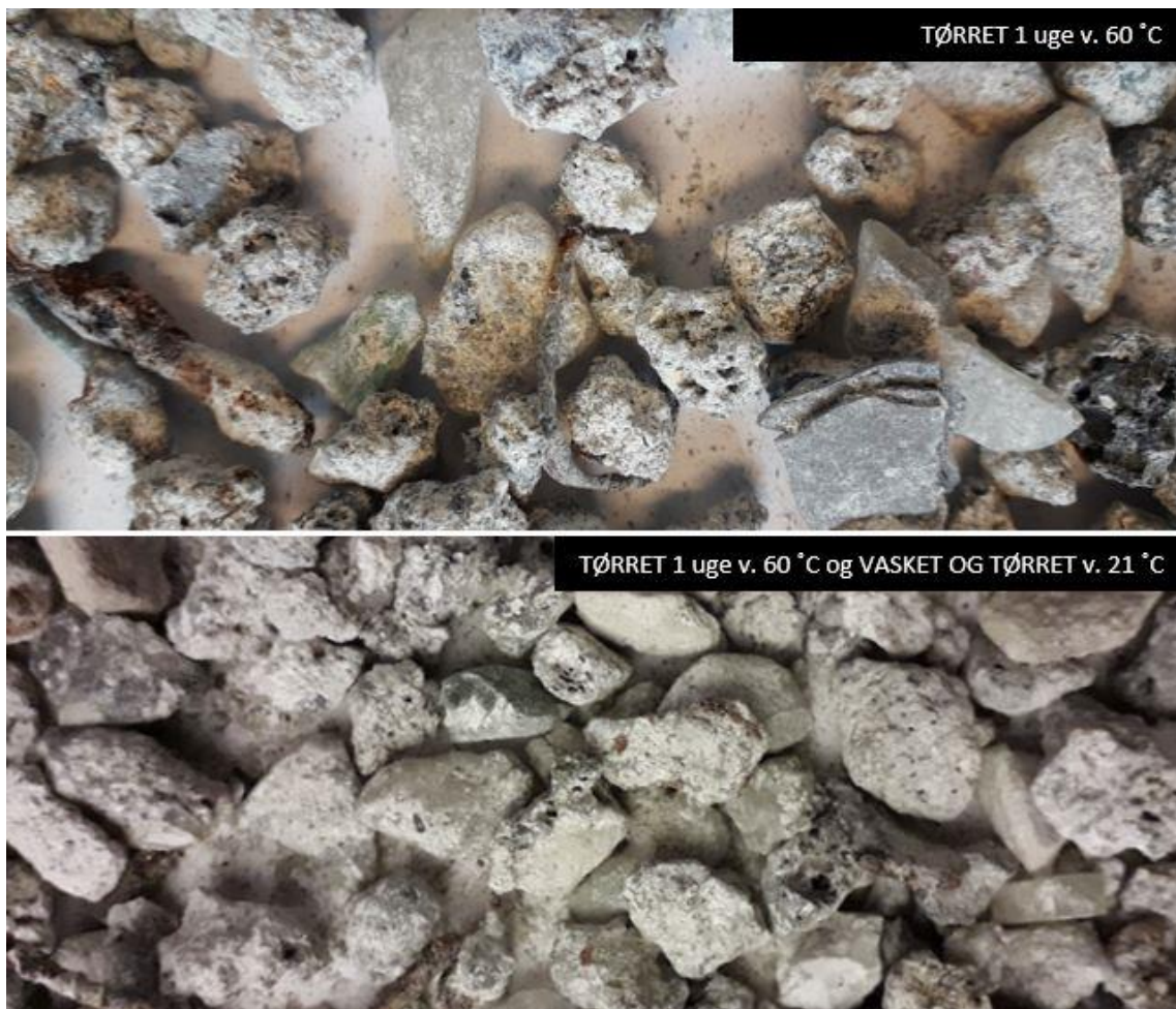
Figur 20. Eksempel på effekten af tørring (øverst) og en kombination af tørring, vask, tørring og syrebehandling på kompositprøve 567662 B, fraktion 4-8 mm. Den ubehandlede kompositprøve ses øverst i Figur 19.
