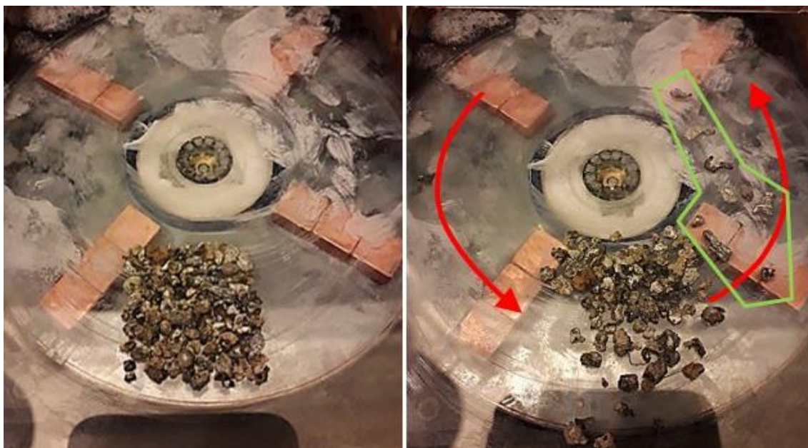
Figur 30. Instrument til frembringelse af Lenz-effekt på 2-4 mm slaggefraktionen og frasortering af ikke-magnetisk metal. Til venstre: slaggefragmenter lagt klar på instrumentet. Til højre: efter 30 sekunders rotation af disken med magneter under plastdækket ses en spredning af fragmenterne; de påvirkede metalfragmenter (i grøn polygon) har bevæget sig i rotationsretningen (rød pil). Den roterende disk er 12 cm i diameter.
