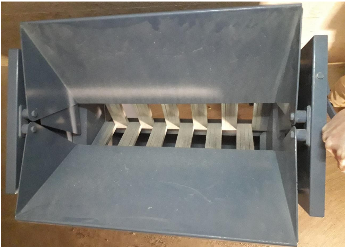
Figur 15. Splitter, anvendt til kompositprøve, set fra oven. Splitteren er ca. 100 cm lang og 65 cm bred og har en kapacitet på ca. 100 l.
