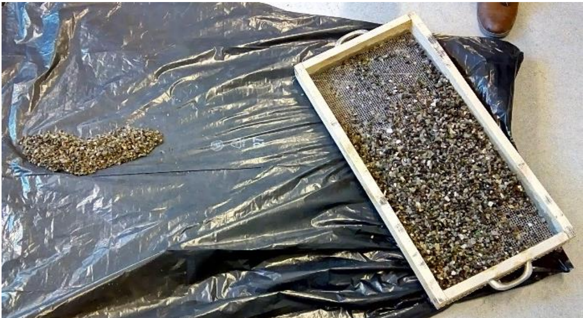
Figur 24. Den endelige sigtning af færdigbehandlet slagge for 2-4 mm fraktionen. Der blev brugt en 2 mm-sigte. Det frasigtede materiale ses til højre.
