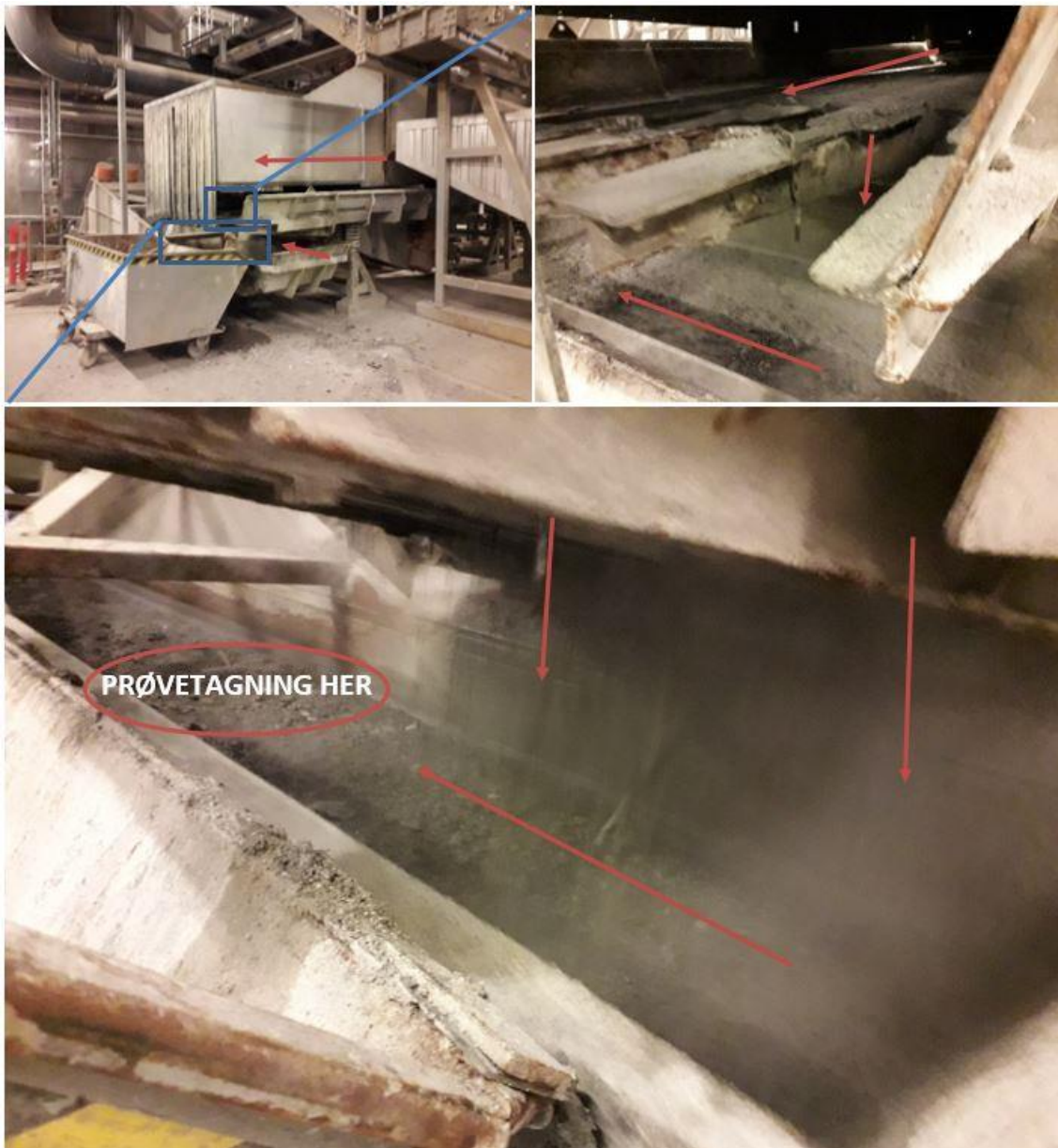
Figur 11. Typisk prøvetagningsområde fra Amager Bakkens WtE-anlæg (punkt 3 i Figur 6). Slaggen falder fra et lukket transportbånd til et åbent transportbånd kort før det ender i slaggesiloen. Bemærk markering af prøvetagningsstedet på det åbne transportbånd. Røde pile markerer slaggens bevægelsesretning.
