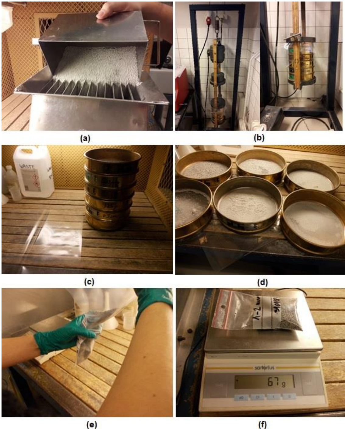
Figur 17. Sigtning af 2 mm-fraktionerne. Prøvematerialet splittes med splitter (a), hvorefter de sigtes i søjle (b) og (c). Det færdigt sigtede materiale ses i (d), fordeles i poser (e) og vejes (f).
