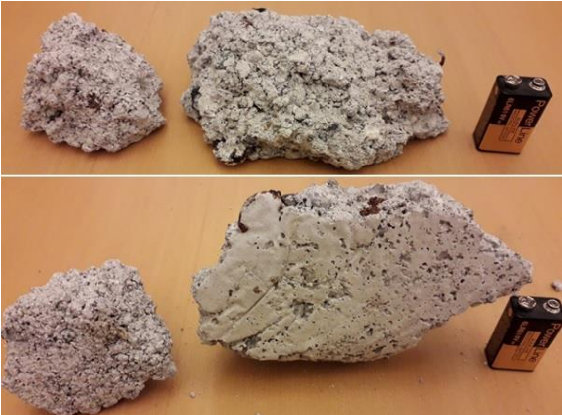
Figur 18. To udvalgte slaggeklumper set fra to vinkle. Til venstre ses en middelhård slaggeklump på 260 g fra prøve 567613-3/4. Til højre en hårdere slaggeklump på 700 g fra prøve 567618-3/4. På nederste billede ses prøverne fra den side, der vendte mod sækkens bund under størkningen; den hårdeste klump til højre er mere glat, næsten ligesom hærdet beton. 9V batteri for skala.
