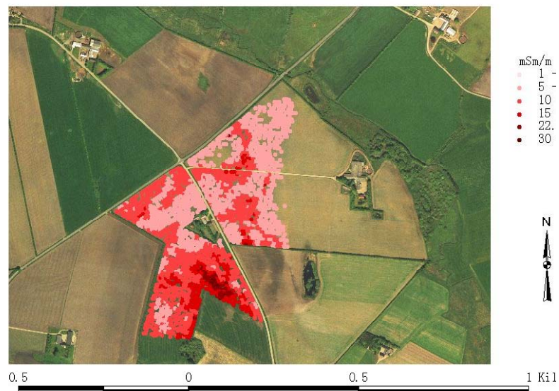
Figur 2.8. Hjortkær – resultater fra målinger med den elektromagnetiske EM38 sensor. Figuren viser målinger af jordens elektriske ledningsevne målt i millisiemens pr. meter. Omkring undersøgelsesprofilet (figur 2.10) findes måleværdier i intervallerne 5 – 10 og 10 – 15 millisiemens/meter.
