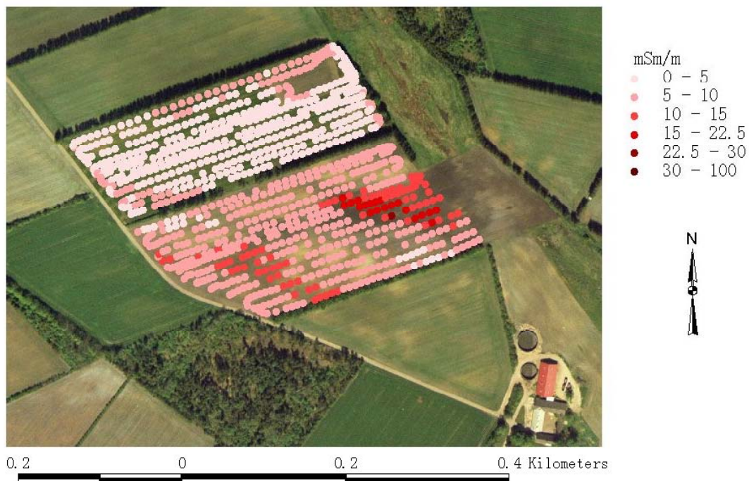
Figur 2.5. Alle – resultater fra målinger med den elektromagnetiske EM38 sensor. Figuren viser målinger af jordens elektriske ledningsevne målt i millisiemens pr. meter. Værdier i området 0-5 mS/m (lys) ses i det nordlige område, mens målinger på 5-10 (lyserød) dækker det største areal. Måleværdier > 10 ses i to lavtliggende områder og skyldtes forhøjet humusindhold i overjorden.
