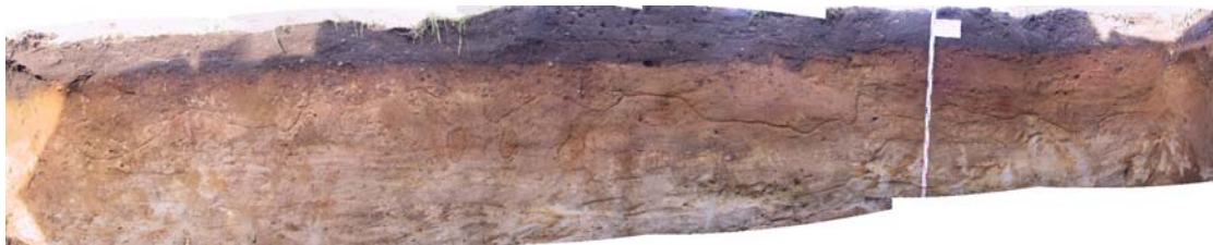
Figur 3.9. Foto af østnordøst-vestsydvest profilvæg ved Lille Knivsig. Fotoudsnittet udgør ca. 9 meter i længden og ca. 1,9 meter i dybden. Billedet er en smule forvrænget.
