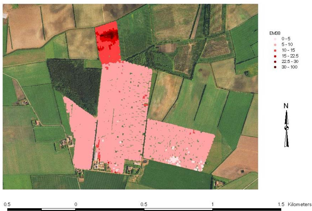
Figur 2.10. Knivsig-resultater fra målinger med den elektromagnetiske EM38-sensor. Figuren viser målinger af jordens elektriske ledningsevne målt i millisiemens pr. meter. Der findes måleværdier i intervallerne 5-10 og 10-15 millisiemens/meter. Enkelte områder i den østlige del har lave værdier på 0-5 millisiemens/meter. De højere værdier på den nordlige mark skyldes forhøjet humusindhold i pløjelaget på den lavtliggende mark ned til åen.
