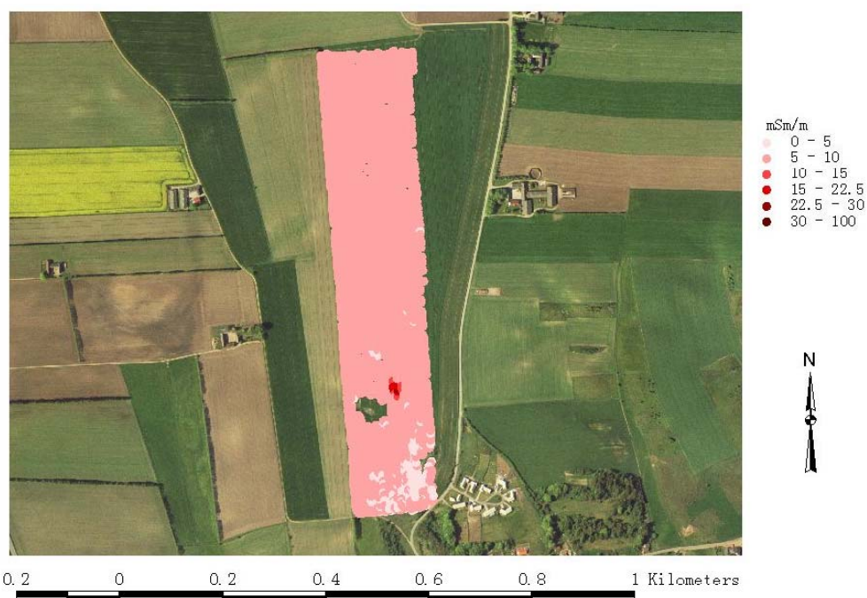
Figur 2.9. Resultater fra EM38-undersøgelsen af Låstrup lokaliteten. Figuren viser målinger af jordens elektriske ledningsevne målt i millisiemens/meter. Størstedelen af området viste måleværdier på 5 - 10 mSm/m (lyserød). Måleværdier på 0 - 5 mSm/m fandtes kun få steder (lys). Højere værdier 10 - 15 og 15 - 22.5 mSm/m fandtes kun pletvis og er atypiske (rød og mørkerøde).
