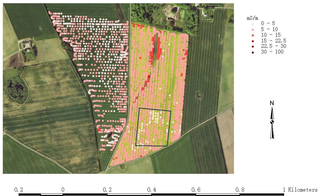
Figur 2.3. Resultater fra målinger med EM38 sensoren ved Sjørup lokaliteten. Figuren viser målinger af jordens elektriske ledningsevne målt i millisiemens/meter. Størstedelen af området viste måleværdier på 5-10 mS/m (lyse og lyserød). Måleværdier på 10 - 15 mS/m fandtes kun få steder (rød). Højere værdier 15 – 22.5 mS/m findes kun pletvis og er atypiske (mørkerøde).
