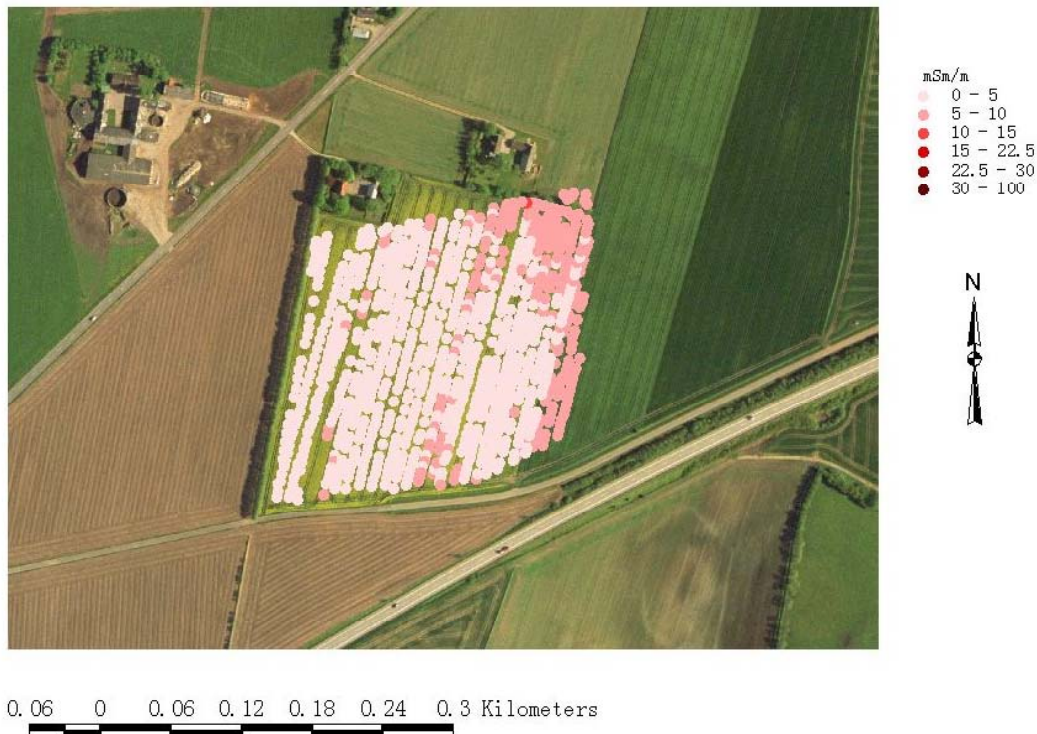
Figur 2.6. Resultater fra målinger med EM38 sensor ved Braulstrup lokaliteten. Figuren viser målinger af jordens elektriske ledningsevne målt i millisiemens/meter. Størstedelen af området viste måleværdier på 0 - 5 mSm/m (lys farve). Måleværdier på 5 - 10 mSm/m fandtes kun få steder (lyserød). Højere værdier 10 - 15 mSm/m fandtes kun pletvis og er atypiske (mørkerøde).
