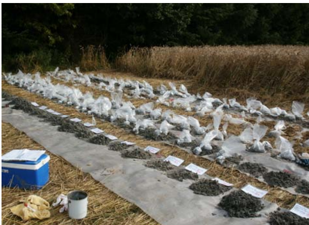
Figur 24: overskuelig oplægning af jordprøver på borepladsen. Foto: Tom Martlev Pallesen.
