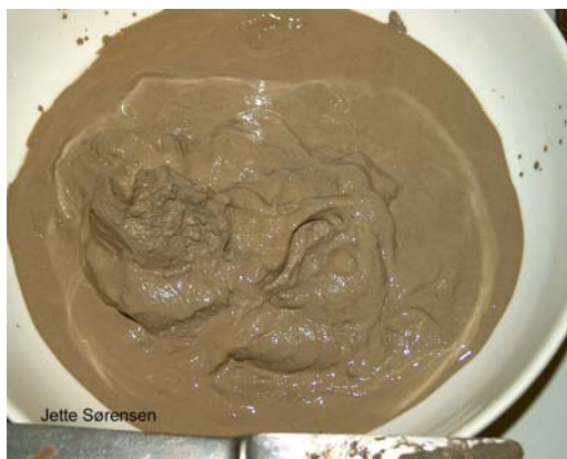
Figur 1.3c. Prøve løsboret med rullemejsel i lufthæveboring.
