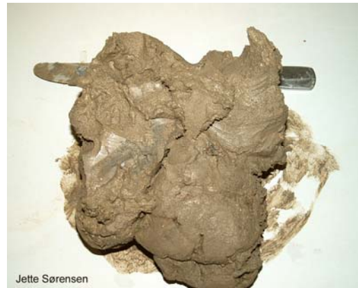
Figur 1.3b. Prøve løsboret med vingemejsel i lufthæveboring.
