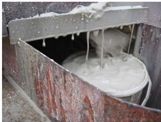
Figur 2.5b. Opsamling af prøve i sedimentfang med tragt.
