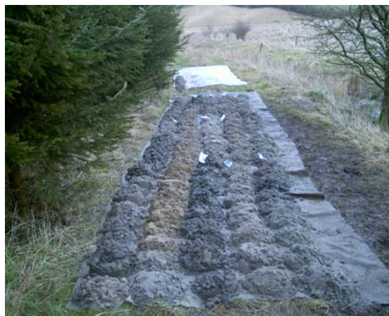
Figur 3.1b. Prøverne er udlagt for tæt.
