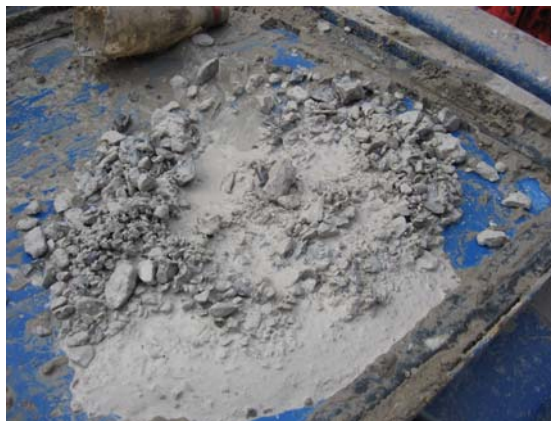
Figur 1.10. Prøve fra DTH boring i kalk og flint. GEO-Aarsleff JV. Foto: Jette Sørensen
