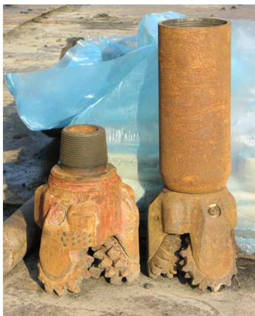
Figur 1.5. Eksempel på rullemejsel. Foto: Tom Martlev Pallesen.
