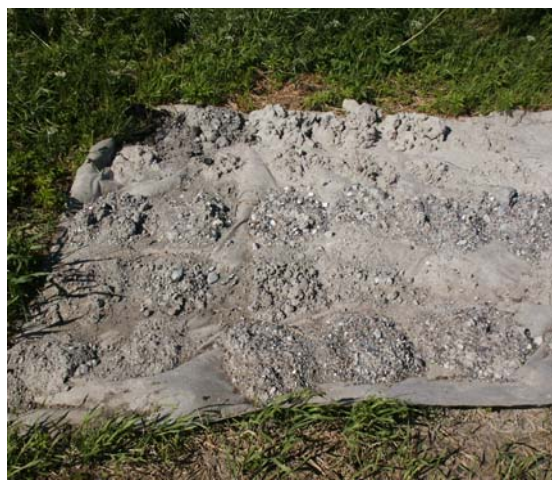
Figur 3.1d. Prøver flydt sammen pga. regn.
