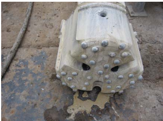
Figur 1.9. DTH borekrone med hårdmetalstifter. GEO-Aarsleff JV. Foto: Jette Sørensen
