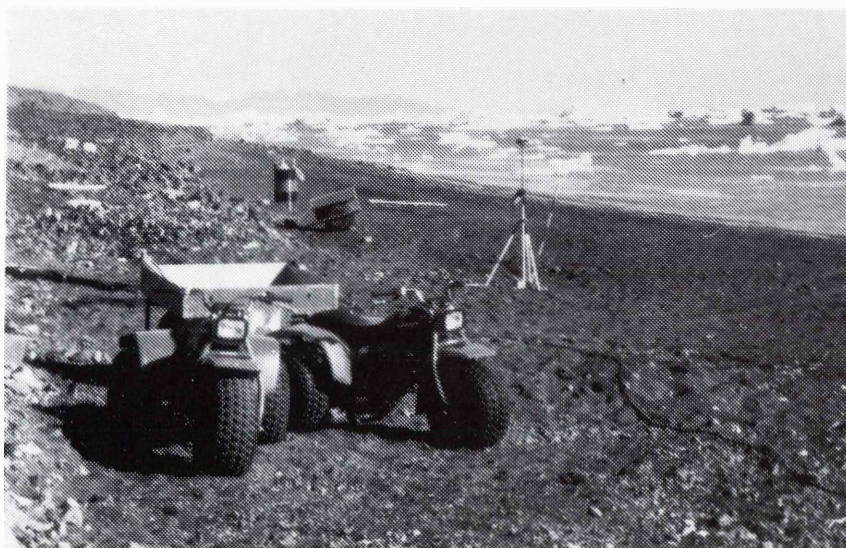
Seismisk dataindsamling langs sydkysten af Nuussuaq, Vestgrønland. Transporten af det seismiske udstyr i undersøgelsesområderne foregik dels med motorcykel, dels med gummi-båd. På billedet ses antennen til GPS-udstyret, der blev brugt til positionering af den seismiske linie.
