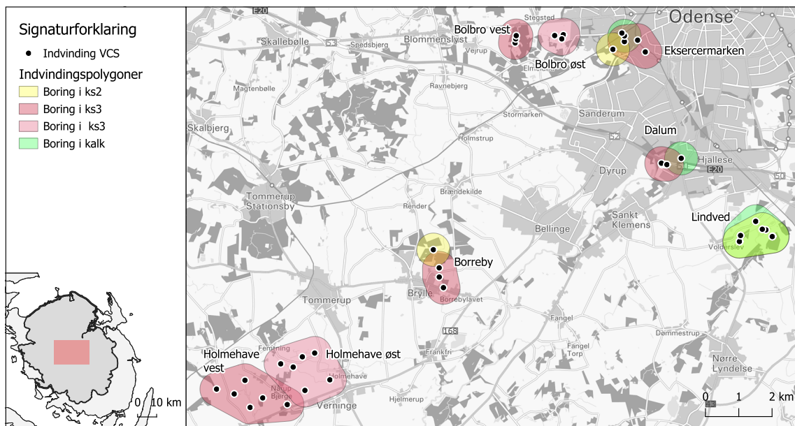
Figur 2.2: Kildepladspolygoner på de fleste af VCS' aktive kildepladser (undtagen Lunde, som ligger længere nordpå). Farverne indikerer de forskellige lag, indvindingsboringerne befinder sig i. KS2 og KS3 er kvartære sandlag hvorfra der indvindes grundvand.
