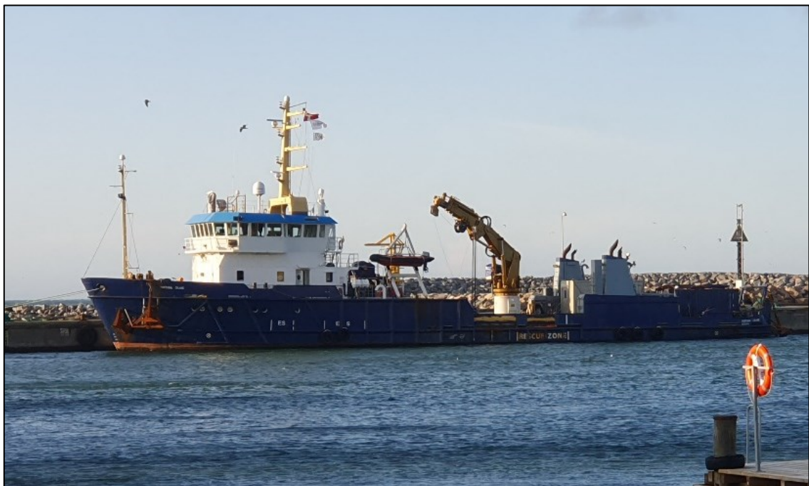
Figur 2.1. MS Fortuna Crane anvendt til vibrationsboring.
