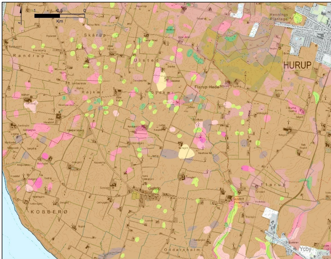
Figur 3-17. Dødislandskab med afløbsløse huller i morænefladen med postglaciale aflejringer af tørv, sand og ler. Se Figur 3-1 for legende.
