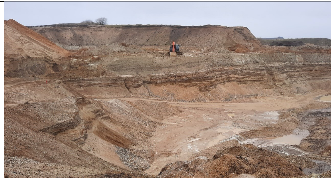
Nors Grusgrav med lagdelt sand og grus nederst. Gravemaskine står på mellemliggende bænk af moræneler. Øverst og bag gravko ses øvre sekvens af sand og grus med en tynd stribe mørk pløjejord til at markere naturligt terrænniveau. Foto: Henrik J. Granat.
