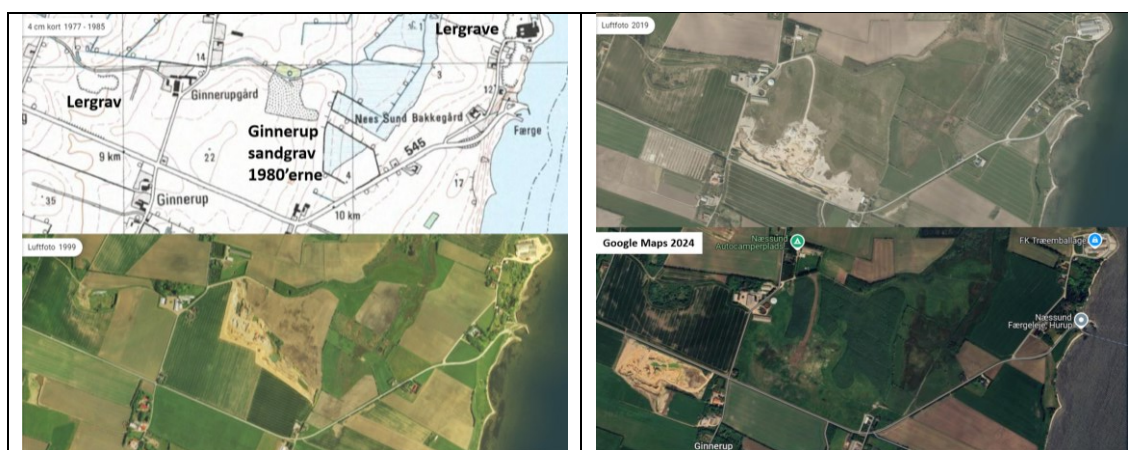
Figur 6-30: Sand og grusgravning ved Ginnerup fra 1980'erne frem til 2024. Gravefronten har på godt 40 år bevæget sig knap 1 km mod sydvest. På 4-cm-kortet fra 1977-1985 ses desuden stiplede linjer, der markerer lergrave, som i dag ikke længere er aktive. Kort og luffotos fra HistoriskAtlas.dk samt Google Maps 2024.
