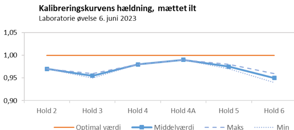
Figur 3. Kalibreringskurvens hældning for iltelektroden. Variationer indenfor og mellem holdene, ved 2–6 gentagne kalibreringer. Optimal værdi er 1,00.
