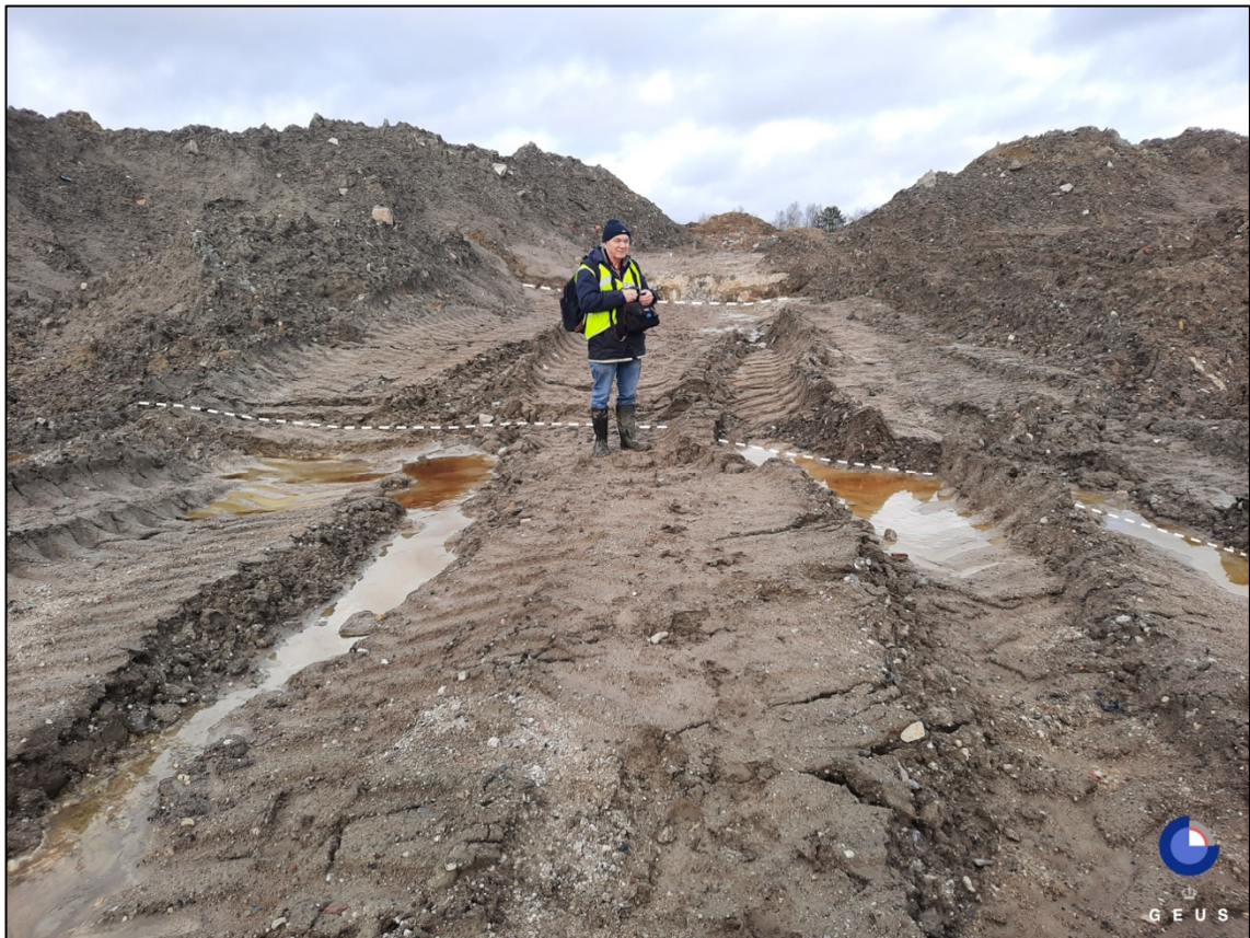
Figur 4. Eksempler på sprækker i den deponerede jord i området nord for jordskreddet. Geologen i billedet står ved en større sprække, der forskyder hjulsporene, hvilket viser, at der både har været bevægelse ned og til siden. Mindre sprækker ses mange steder, og en anden større sprække ses lidt længere væk. De to største sprækker er markeret med stiplede hvide linjer. Billedet er taget i retning mod nord.
