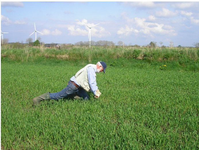
Figur 3. Det 1 meter lange jordspyd presses ned i jorden. Prøven sidder i en rille i spidsen. Jordarten bestemmes på stedet, og resultatet indtegnes på feltkortet.
