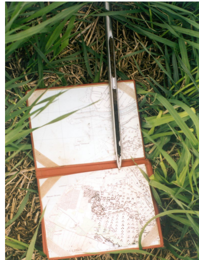
Figur 3. Det 1 meter lange jordspyd presses ned i jorden. Prøven sidder i en rille i spidsen. Jordarten bestemmes på stedet, og resultatet indtegnes på feltkortet.
