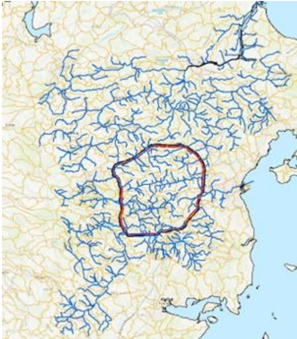
Figur 37. Eksempel for Århus Vest hvor alle modelvandløb (branches) indenfor oplandene hørende til detailmodelområde beholdes.
