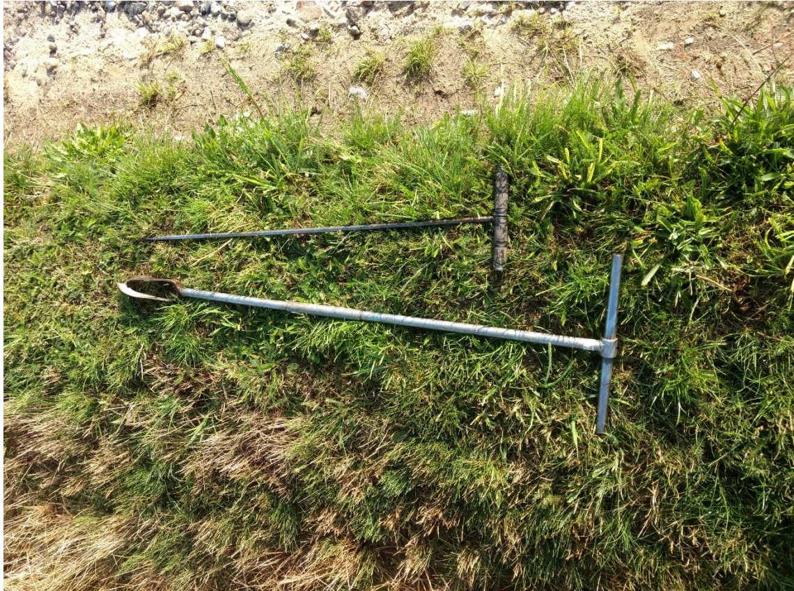
Figur 2. Jordspyd og håndbor benyttet ved kortlægningen. Der bores til 1 m mærke på håndboret.
