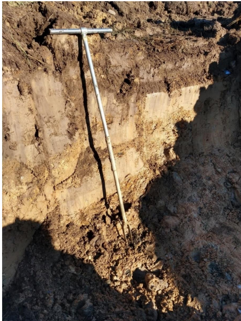
Figur 10. Udgravning til jordvarmeanlæg i Enner By. Nederst (i skygge) ses stenet, stærkt siltet moræneler. Herover træffes velsorteret silt der for modentlig er vandaflejret. Se figur 25 for lokalisering.
