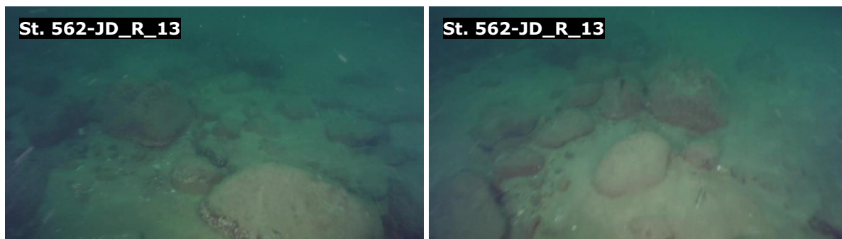
Figur 20 Direkte påvirkning af sedimentoverlejring fra sandindvinding.
