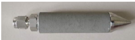
Billede af de sugeceller i rustfrit stål, som blev anvendt (Prenart, Supersteel). Diameter er 20 mm. Gennemsnitlig porestørrelse er 0,05 µm.
