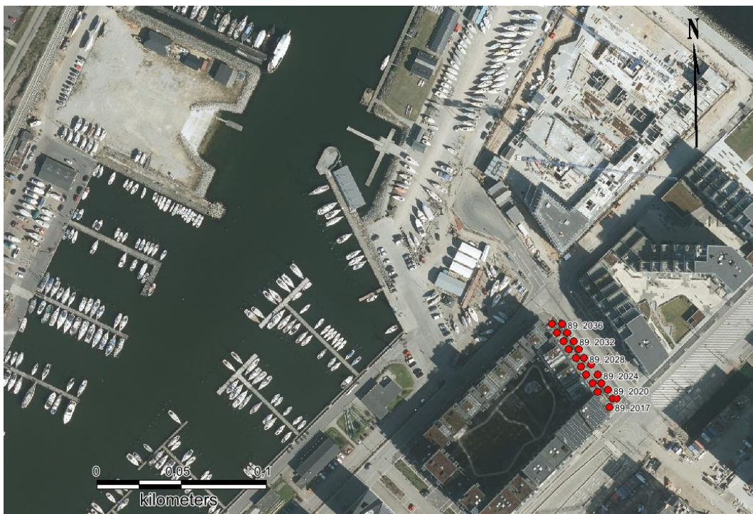
Figur B. kombinerede BHE og BTES borer ved lokalt jordvarmeanlæg, Havnehusene Aarhus Ø.
