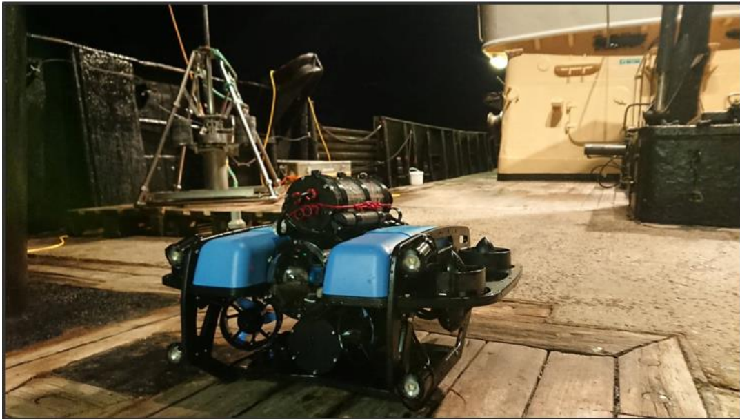
Figur 3-9. WSPs ROV - BLUEROV2 FRA BLUEROBOTICS
