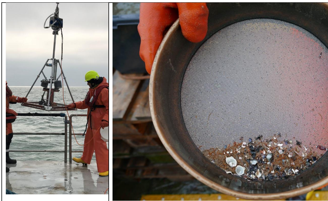
Figur 3-8. På billedet til venstre ses HAPS umiddelbart før prøven tages ud. Billedet til højre viser sigteresten, som efterfølgende fikseredes i ethanol.
