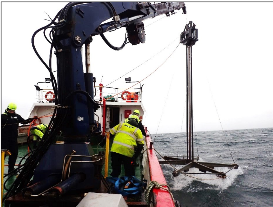
Figur 5. Vibrocorer udsættes over skibssiden på MS Skoven.
