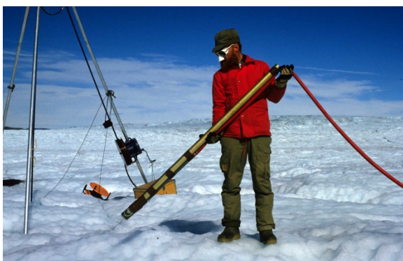
Fig. 17A. "Ølboret" præsenteres af Ole B. Olesen før den nedsættes i isen. Det bemærkes at "borekronen" er en Carlsberg dåse, som ved hjælp af sine talrige huller skal udlede det varme vand for at smelte sig vej ned gennem isen. 17B:Fra venstre mod højre ses: Anders Clausen (tekniker), forfatteren og Ole B. Olesen (glaciolog) i færd med at gøre klar til boring. Foto: Henrik Højmark Thomsen.
