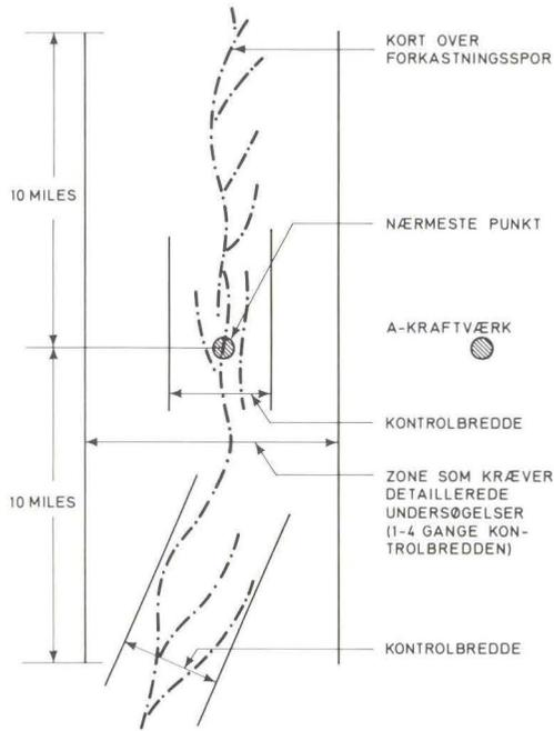
Fig. 1. Skitse visende procedure for afgrænsning af zonen, som kræver detaljerede geologiske undersøgelser forud for opførelse af A-kraftværker.
