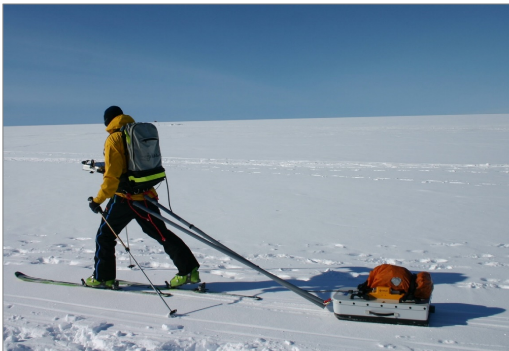
Figur 1: Radarantennen trukket på ski over sneoverfladen
