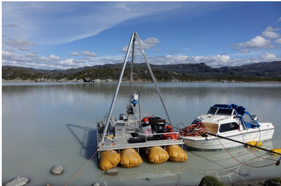
Figur 3. Den mobile platform på oppustelige pontoner, her monteret med vibrocore boreudstyret på en sø i Grønland.
