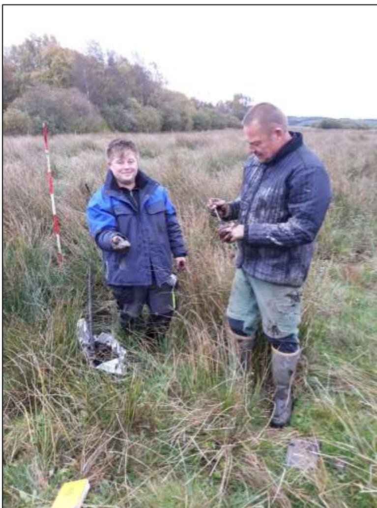
*Figur 8: Geologisk karakterisering af jordbundsforholdene med "Eijkelkamp" håndboregrej. Boprøve tjekkes for kalkindhold med 10% saltsyreopløsning.*
