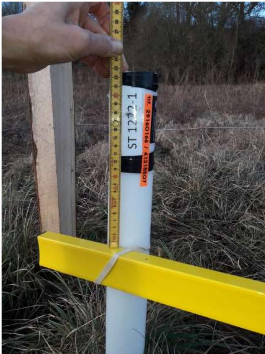
Figur 7: Indmåling af den indbyrdes højdeforskel på rørtoppene med vaterpas og tommelstok
