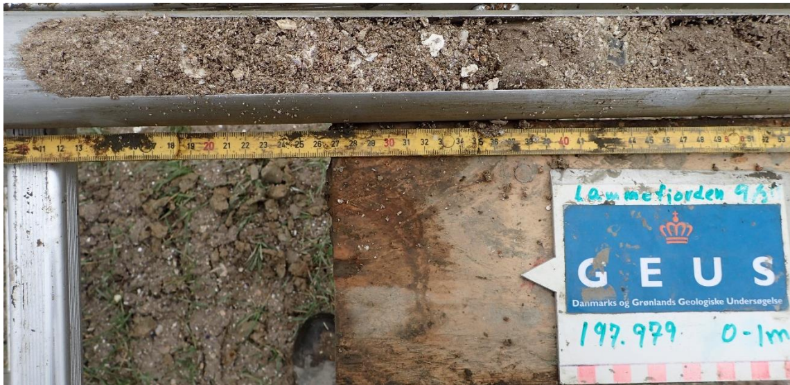
Fig. 2.2. Skiftende lag af skalgrus og sand i boring 197.679.
