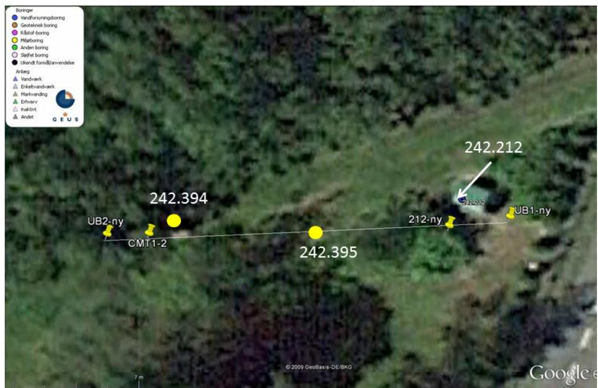
Figur 7. Omtrentlig lokalisering af boring 242.394 og 242.395 (gule cirkler) i forhold til Marielyst Vandværks boring nr. 9 (DGU nr. 242.212) og tidligere boringer udført i testfeltet (gule pinde). Boringerne er placeret hhv. nord og syd for stikvejen mellem Bøtø Ringvej og Marielyst golfbane. Boring 242.394 står i skel mod nordliggende mark ligesom boring UB2 og CMT-1-2 boringerne.
