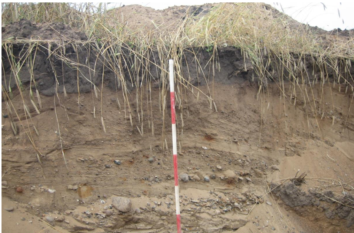
Figur 14. Sand- og gruslagene i den sydligste ende af GR1 (ca. 100 m) hælder kun svagt mod N. Trugkrydslejring af smeltevandsgrus tyder på, at smeltevandsstrømmen har gået fra en østlig til en vestlig retning svarende til strømløb parallelt med overskydningsfronten.
