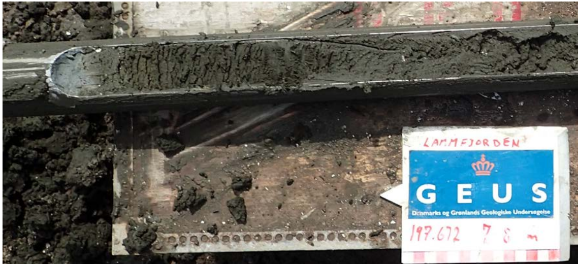
Figur 5. Boring 197.672. Overgang mellem gytje og moræneler i 7,9 m u.t.
