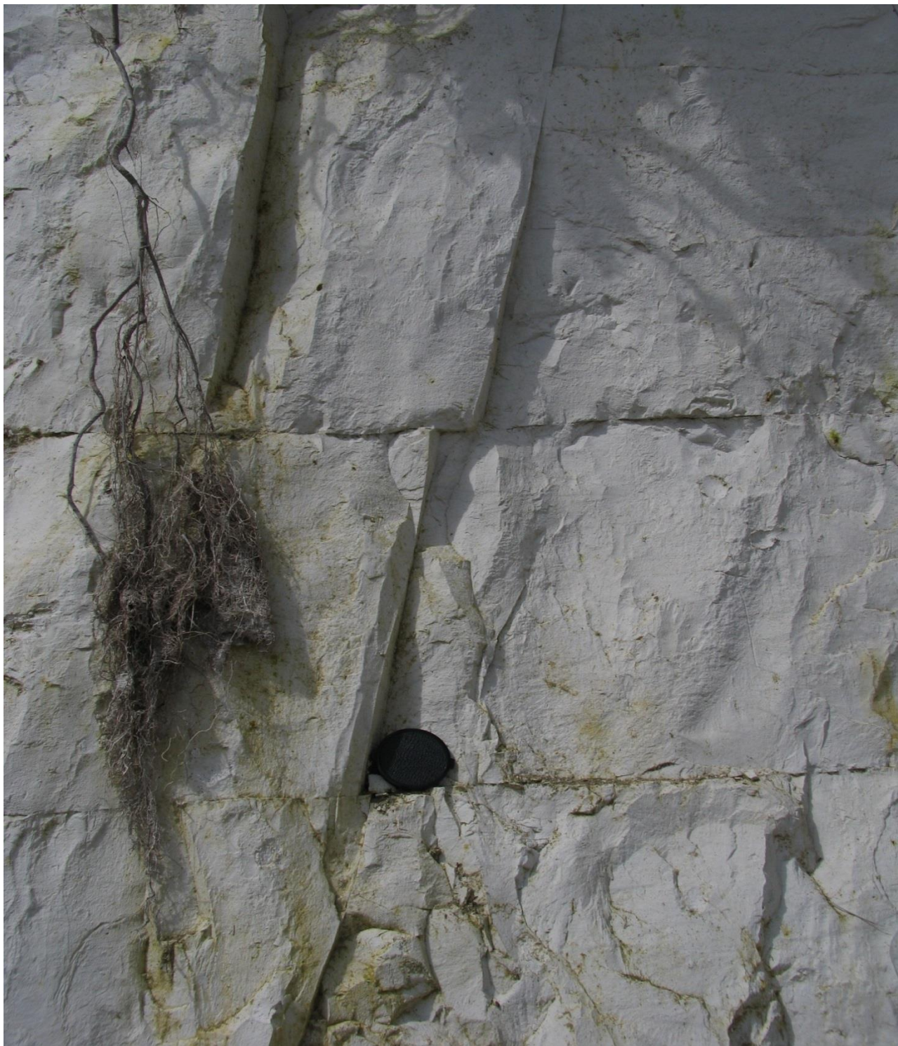
Figur 7. Horisontale sprækker i skrivekridtet skærer en næsten lodret sprække. (Foto: Merete Binderup).
