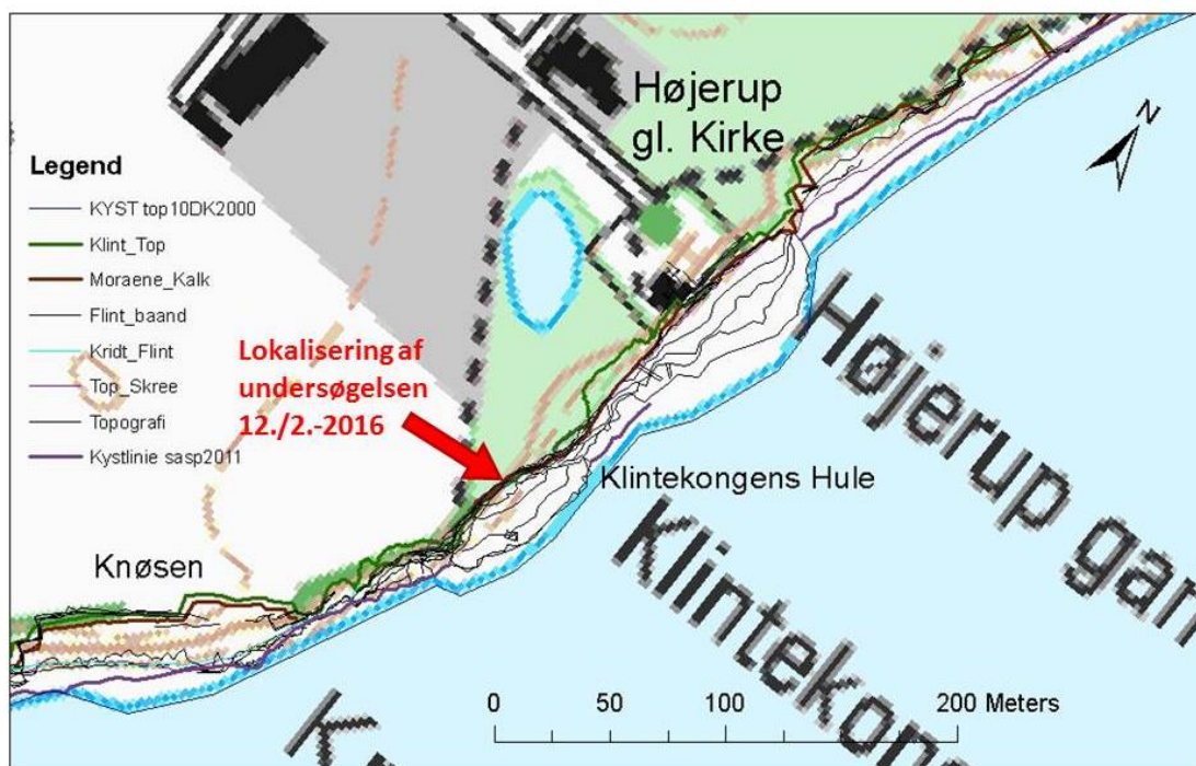
Figur 21. Lokaliseringen af stedet på toppen af skredet ved Klintekongens Hule. Skredkeglerne neden for klinten er markeret ved sorte højdekurver (Topografi i legenden) med en ækvidistance på 2,5 m.
