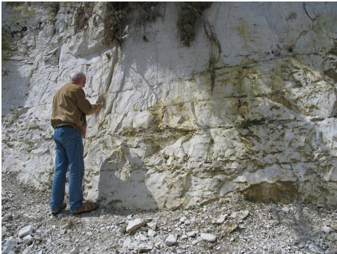
Figur 6. Markante horisontale sprækker i skivekridt (Foto: Merete Binderup).
