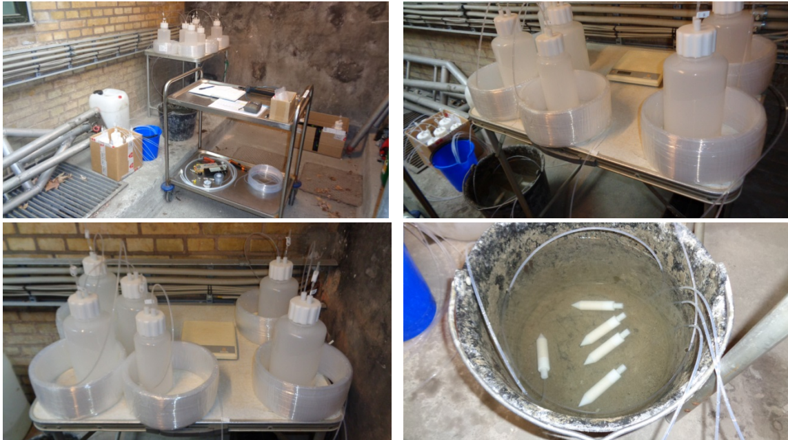
Figur 2-1. Test 2: Laboratorieopstilling til test af slangelængder, flaskestørrelser og startvakuum
