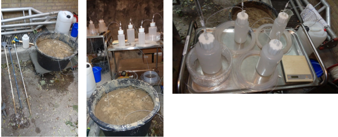
Figur 2-4. Test 3: Laboratorieopstilling til test af slangelængder, flaskestørrelser og startvakuum
