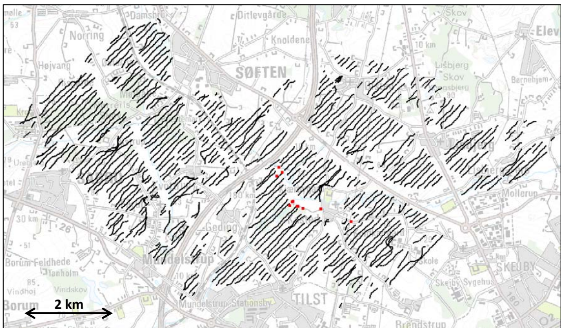
Fig. 6: 1D-sonderinger fra SkyTEM-surveyet indsamlet i august 2013 vist sammen med baggrundskort. De røde prikker viser indvindingsboringerne ved Kasted.
