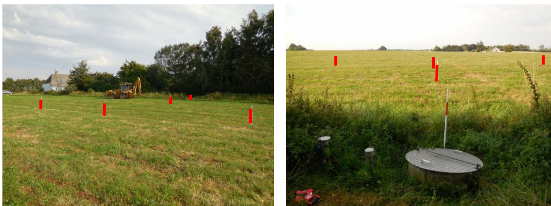
Figur 1-3. Stationsmark set fra syd (venstre) og set fra nord med opsamlingsbrønd i forgrunden (højre). Målepinde viser placering af sugecellefelt
