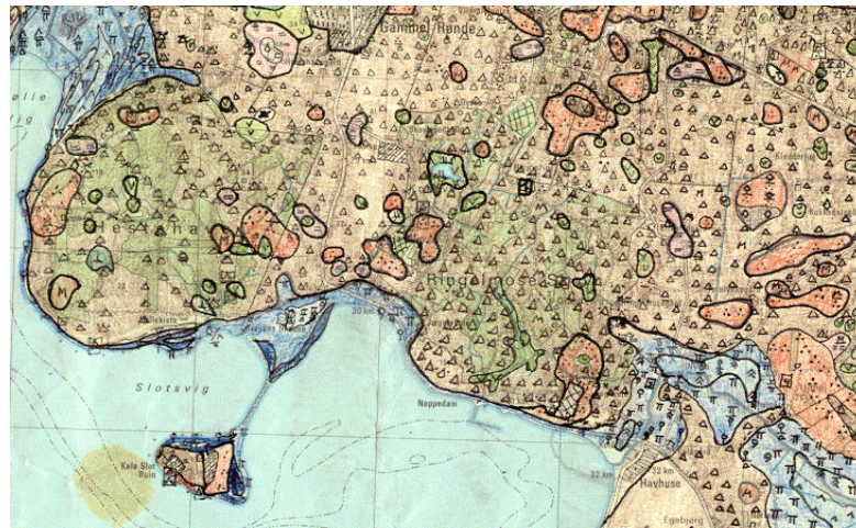
Figur 5. Et udsnit af rentegnet feltkort med karteringstegn og jordartsafgrænsninger fra 4cm kortet 1315 II SV Rønne..
