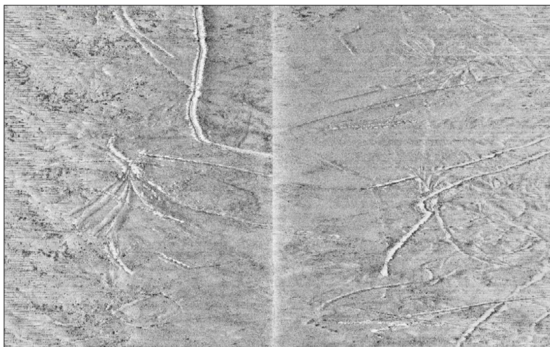
Figur 8-10 Side- scan sonar billede af opankringsspor. Billedet dækker et område på ca. 200 x 200 m.
