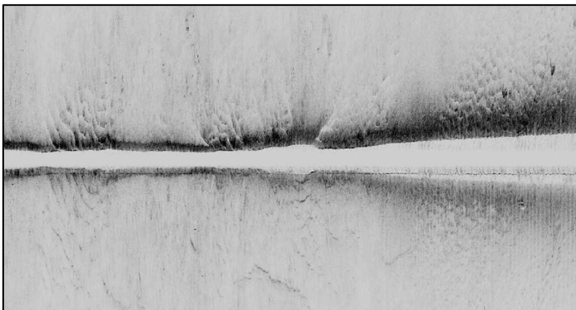
Figur 7-11 Side scan sonar billede af område med spor efter sandindvinding. Billedet dækker et område på 100 m på hver side af sejlrøtningen.
