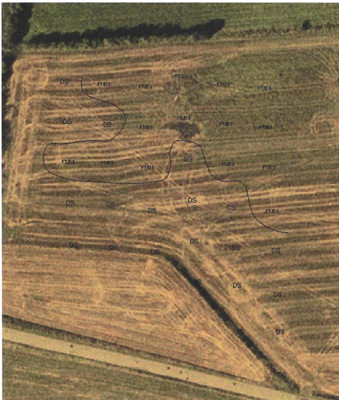
Figur 8: Jordartskarteringen i 20x20 meter net. DS er "diluvialt sand" og FT/DS er "ferskvands tørv" over "diluvialt sand".
