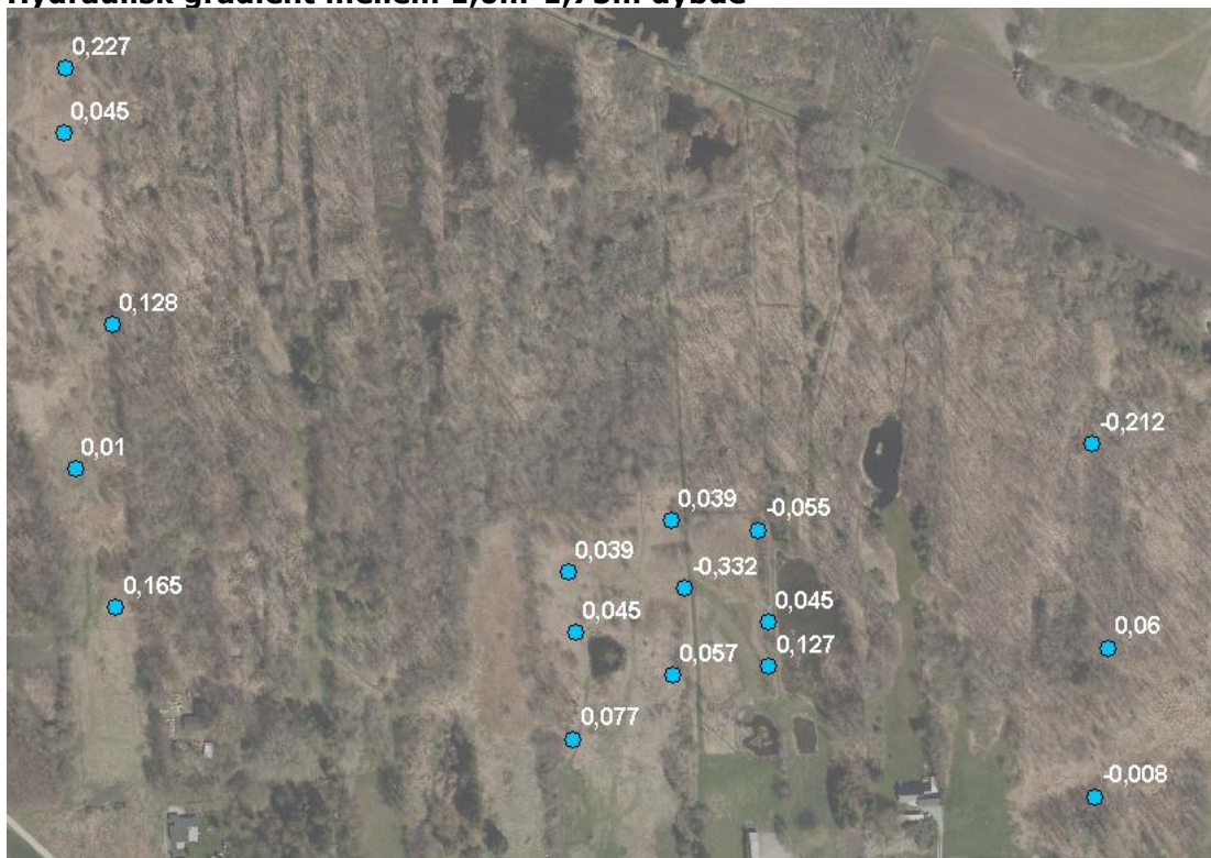
Figur 20b. Forskelle i hydraulisk trykgradient beregnet på baggrund af pejlerunde i juli 2014 i Vasby Mose mellem 3,5 meters dybde og 1,75 meters dybde (øverst), samt mellem 1,75 meters dybde og 1 meters dybde (nederst). Positive værdier angiver en opadrettet strømning og negative værdier angiver en nedadrettede strømning (se også principskitser i Figur 20a).
