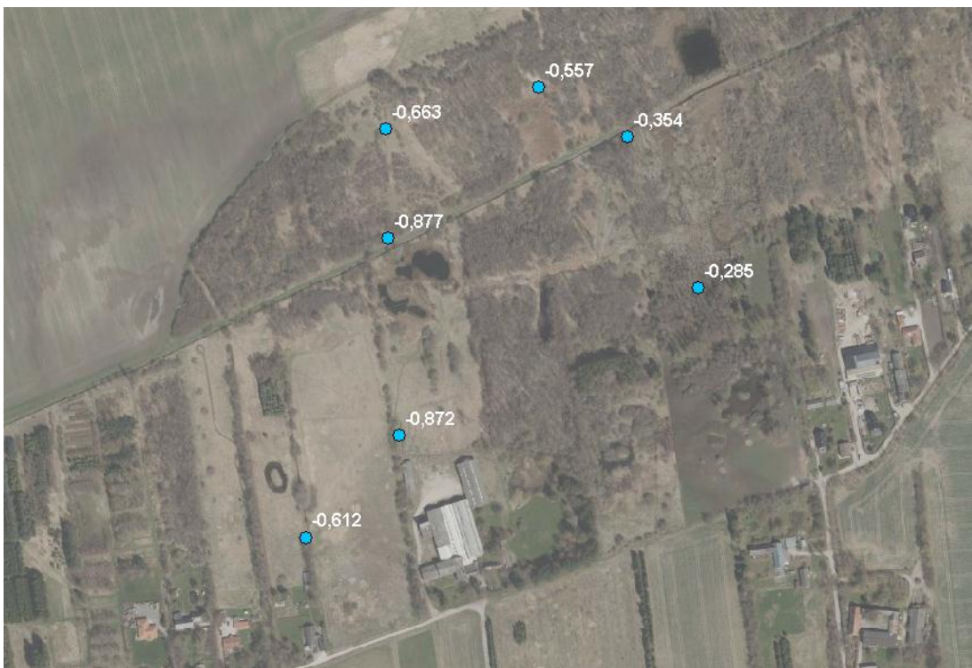
Figur 15a. Vandstanden pejlet i de 1 meter dybe vandstandsør i forhold til terræn, hvor positive værdier angiver vandstand (artesiske forhold) i meter over terræn og negative værdier vandstand under terræn. Øverst: Udbredelsen af arealet med artesiske grundvandsstand i Vasby Mose i juli 2014 (øverst). Nederst: Sengeløse Mose har ingen områder med artesiske grundvand i juli 2014 (nederst). Øverst vises placeringen af statens to NOVANA overvågningsboringer Vasby Mose 1 (rød cirkel) og Vasby Mose 2 (grøn cirkel).
