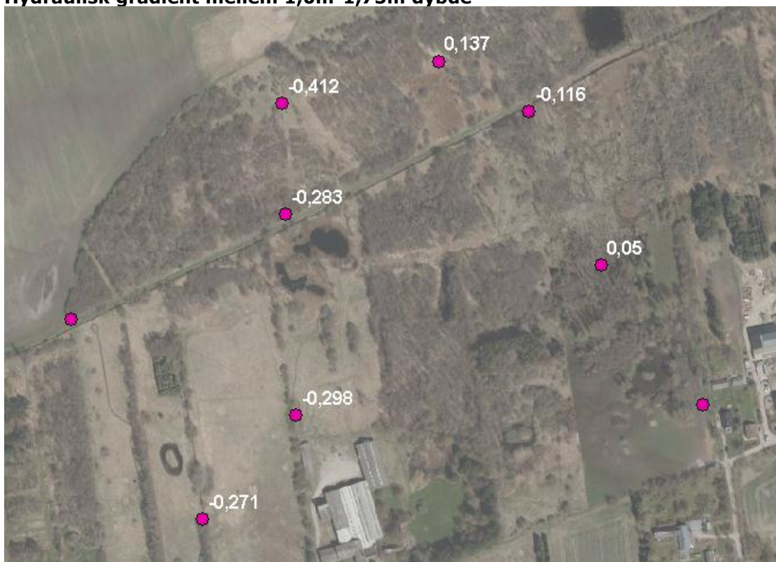
Figur 21. Forskelle i hydraulisk trykgradient beregnet på baggrund af pejlerunde i juli 2014 i Sengeløse Mose mellem 3,5 meters dybde og 1,75 meters dybde (øverst), samt mellem 1,75 meters dybde og 1 meters dybde (nederst). Positive værdier angiver en opadrettet strømning og negative værdier angiver en nedadrettede strømning (se også principskitser i Figur 20a).
