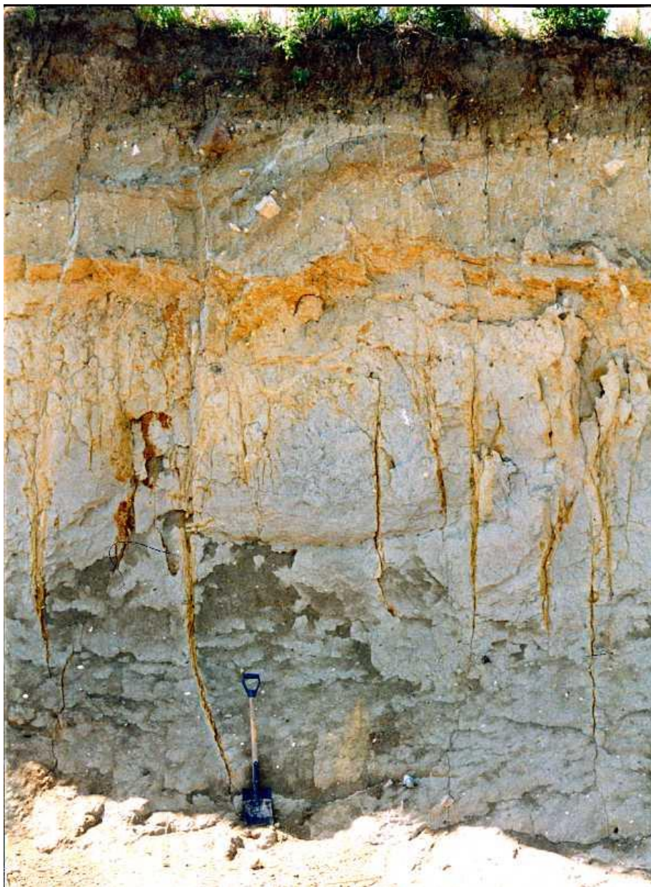
Figur 93. Kystblotning fra Gedserodde på Sydfalster med velblottede sprækker. Bemærk grænsen mellem den oxiderede zone (brun og gulbrun) og den reducerede zone (grå): redoxgrænsen. Linjen bølgjer gennem moræneleret, og den oxiderede del følger rodzoner og sprækker langt ned i den reducerede zone (Foto: K.E.S. Klint).
