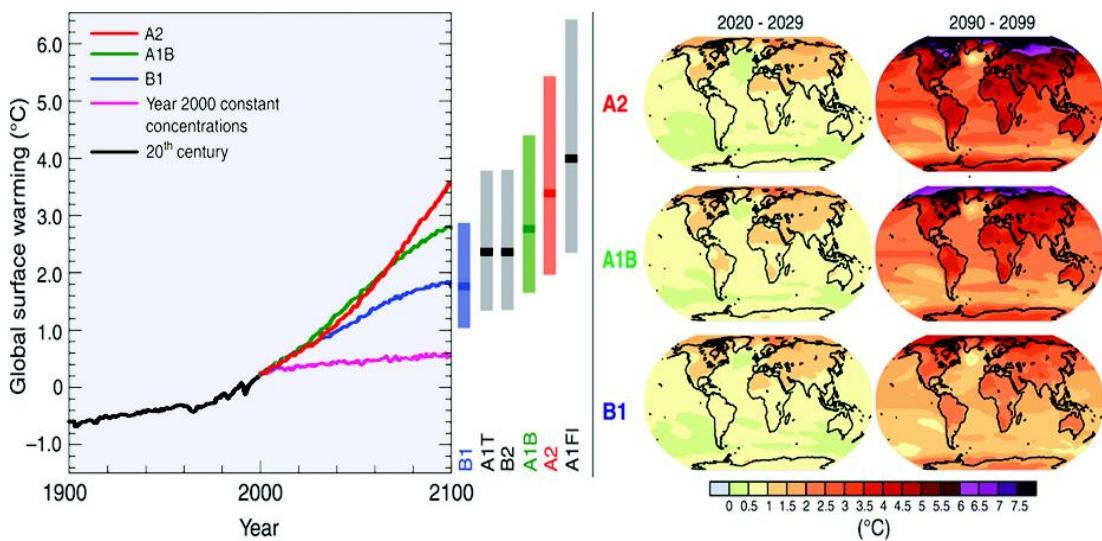
Figur 3.2 Fremskrivning af global opvarmning ( $^{\circ}\text{C}$ ) er baseret på forskellige emissions scenarier. A1B er et middelhøjt scenarie med hensyn til  $\text{CO}_2$  fremskrivning, sammenlignet med de kraftigere A2 og A1FI scenarier men mere moderat end B1, A1T og B2-scenarierne. (Kilde: van der Linden and Mitchell, 2009; IPCC, 2007)
