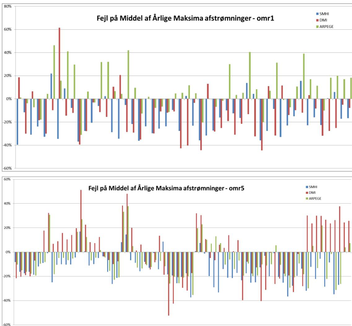
Figur 4.5 Forskel på middel af årlige maksimale afstrømninger som følge af forskel i klimainput opgjort for alle stationer i område 1 Sjælland og 5 Midtjylland for perioden 1991-2010. SMHI: ECHAM-SMHI, DMI: ECHAM-DMI og ARPEGE:ARPEGE-CNRP middel fejl i forhold til kørsel med observeret klima som input.
