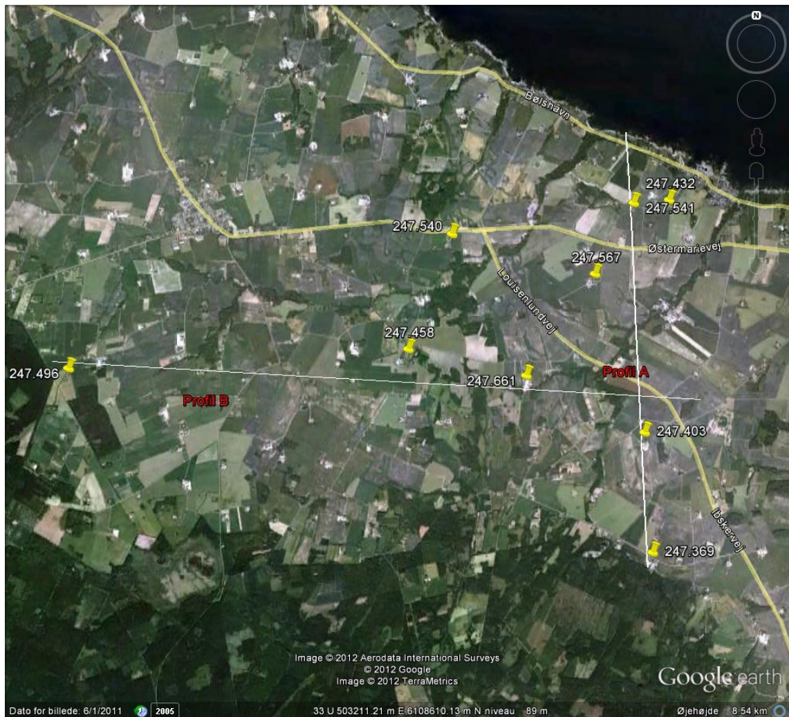
Fig. 14. Oversigtsplan for boringer der indgik i borehulslogging-programmet (8 i alt). Dertil kommer en borehulslog i Østermarie vandværksboring 247.496 fra 2006. De to profiler: A og B er indtegnet.
