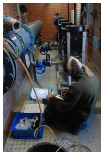
Figur 6. Indsamling af vandprøver den 13. februar 2012. Der blev udtaget vandprøver fra aktive indvindingsboringer samt indgangs- og afgangsvand på vandværket. Flere billeder findes i bilag 2.
