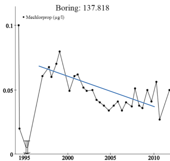
Figur B 8-3. Udviklingen i indholdet af mechlorprop i indvindingsboring 137.610 og 137.818. Data stammer fra Jupiter databasen.
