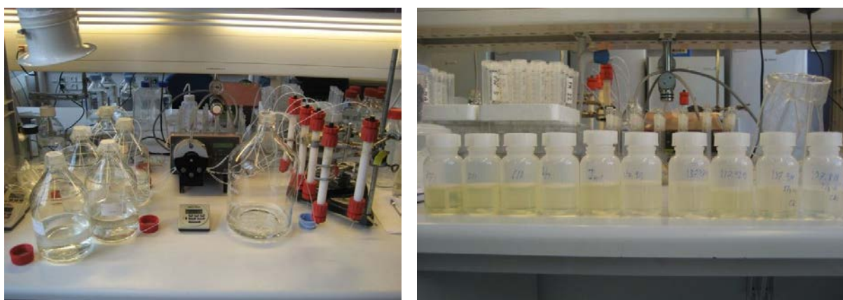
Figur 24. Til venstre: 2L-prøver filtreres gennem kolonner med 30 mL DAX8-resin. Humusstoffer samt hydrofobe uladete molekyler tilbageholdes i kolonnerne. Til højre: Alle opkoncentrerede humusopløsninger inden frysetørring. Tydelig farveforskel fra de tre boreriger omkring vandværket (til venstre) og de tre sydlige boreriger (til højre i billedet). Flere billeder fra oprensningen kan ses i bilag 4.
