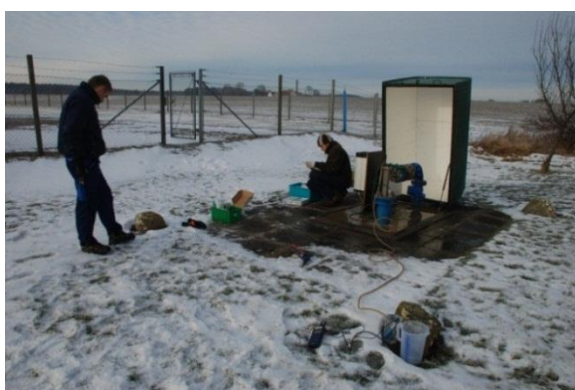
Figur 6. Indsamling af vandprøver den 13. februar 2012. Der blev udtaget vandprøver fra aktive indvindingsboringer samt indgangs- og afgangsvand på vandværket. Flere billeder findes i bilag 2.
