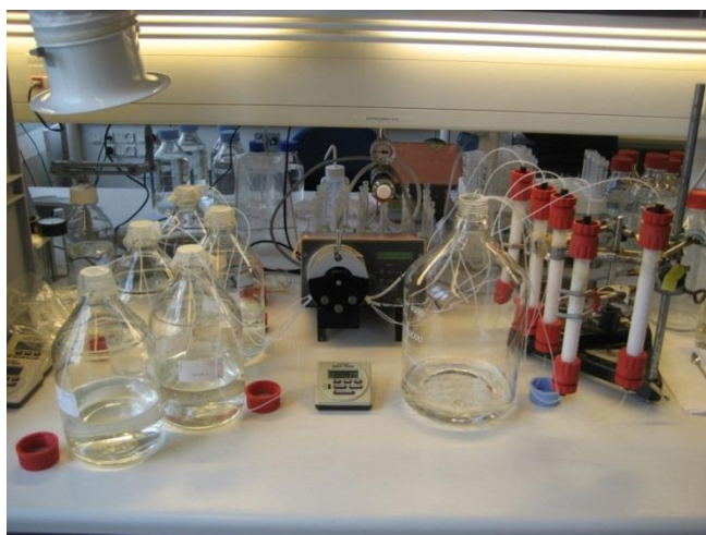
Figur B 4-1. 2L-vandprøver filtreres gennem kolonner med 30 mL DAX8-resin. Humusstoffer samt ikke ladede hydrofobe molekyler tilbageholdes i kolonnerne.
