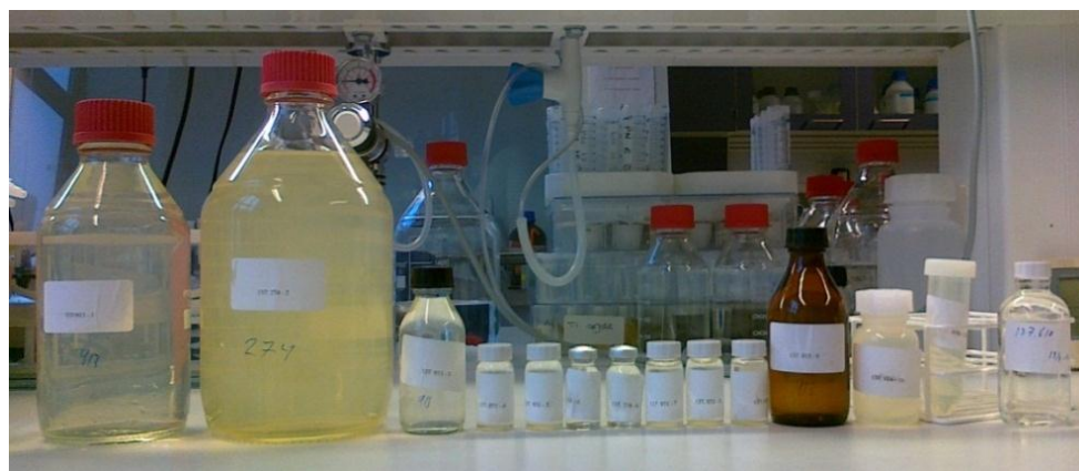
Figur B 2-2. Prøveserie fra en enkelt boring. Den kraftige farve i den største flaske skyldes udfældning af jernoxider.
