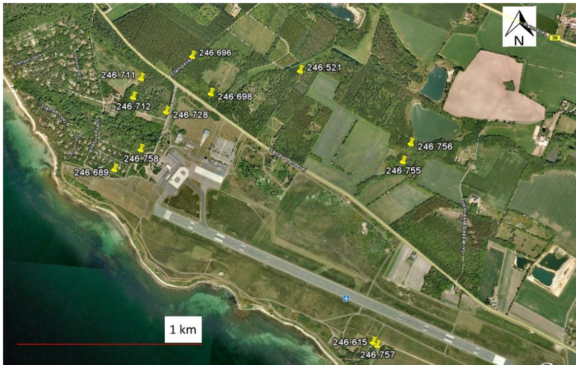
Figur 1: Beliggenhed af de 11 borer i Stampen området med digitaliserede analog-data (246.617 ligger ca. 35 m fra 246.615). Boring 246.760 fra Nyker bassinet ligger nord for dette kortudsnit. Boring 246.689 og 246.696 er borer med digitale log-data fra tidligere undersøgelser.
